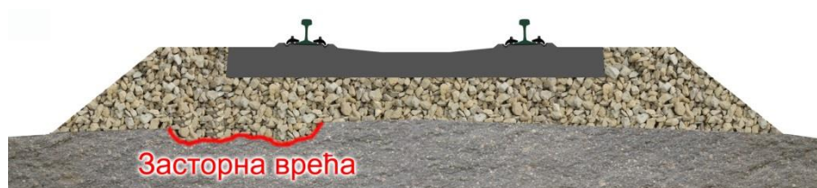
Слика 7.4 Последица слегања доњег строја железничке пруге
