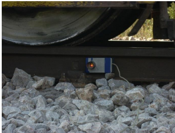
Слика 6.3 Примена оптичког сензора положаја за мерење угиба на прагу
