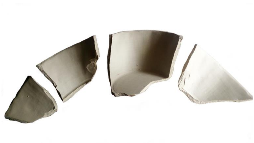
Слика 73. Образац пуцања мање посуде израђене техником моделовања на калупу
