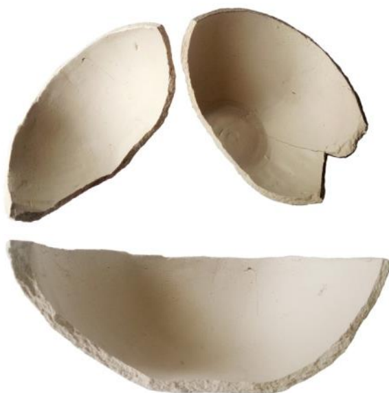
Слика 74. Образац пуцања мање посуде израђене техником моделовања на калупу
