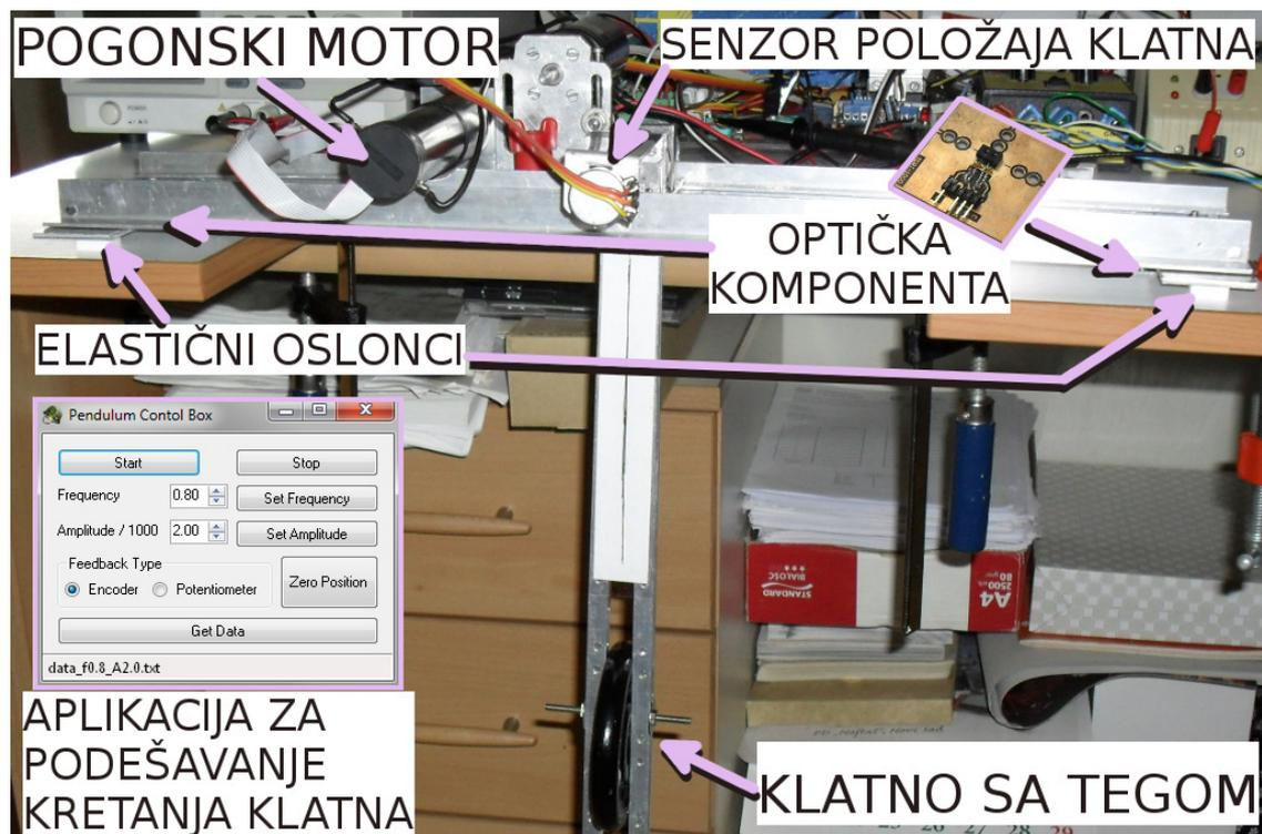
Slika 4.9: Fotografija platforme sa obeleženim ključnim elementima.
