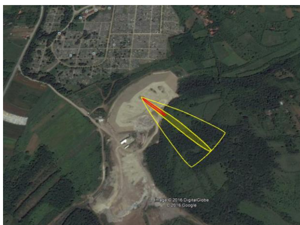
Слика 6.4 - Мапни приказ предикције зоне настанка пожара услед максималне емисије метана са несанитарне депоније "Бубањ" у Нишу
