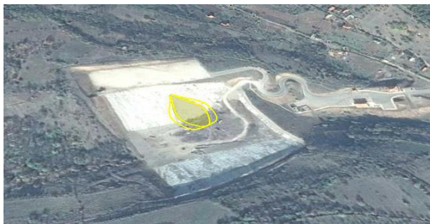
Слика 6.14 - Мапни приказ предикције зоне притиска експлозије услед максималне емисије метана са регионалне санитарне депоније "Мунтина падина" у Пироту
