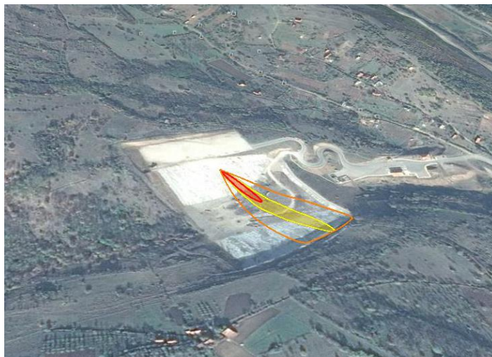
Слика 6.10 - Мапни приказ предикције токсичних зона услед максималне емисије метана са регионалне санитарне депоније "Мунтина падина" у Пироту
