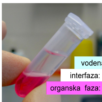
Slika 2. Razdvojene faze u procesu izolacije RNK
