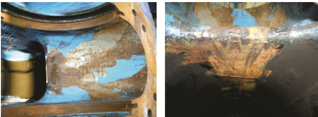
Слика 2.23. Кавитацијска оштећења у на језичку спирале на страни спирале (лево) и на страни излазног дифузора (десно) Двострујна пумпа уграђена у ПС „Штранд“ (ЈКП „Водовод и канализација“ Нови Сад)
