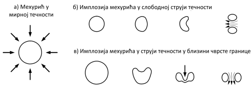
Слика 2.4. Имплозија парног мехурића
