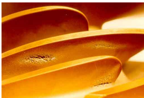
Слика 2.5. Површинска оштећења услед кавитацијске ерозије на лопатицама радног кола полуаксијалне пумпе (Brennen, 1994)
