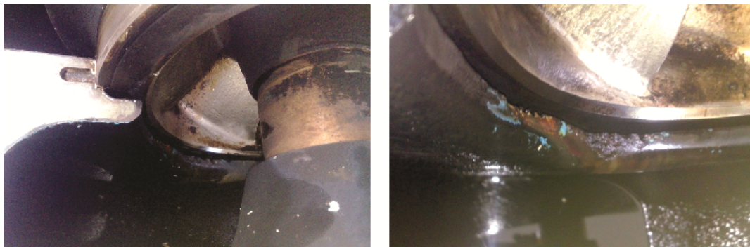
Слика 2.22. Кавитацијска оштећења у зони заптивног прстена Двострујна пумпа уграђена у ПС „Штранд“ (ЈКП „Водовод и канализација“ Нови Сад)
