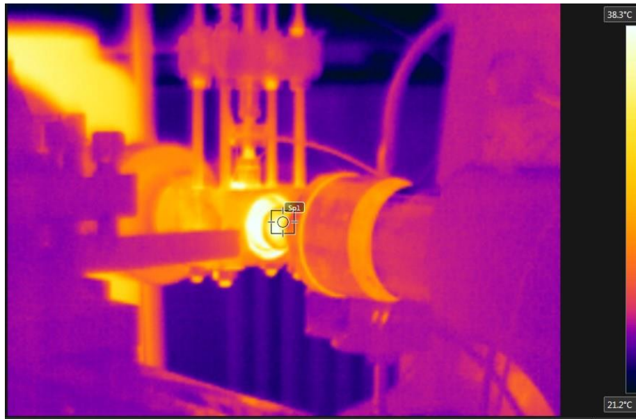
Слика 81. Температура мерена код самоподмазујућег лежаја 12_20_265_1500 T = 34.7^{\circ}\text{C}
