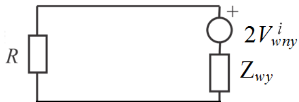
Slika 3.10 Otporno opterećenje na jednom kraju žice
