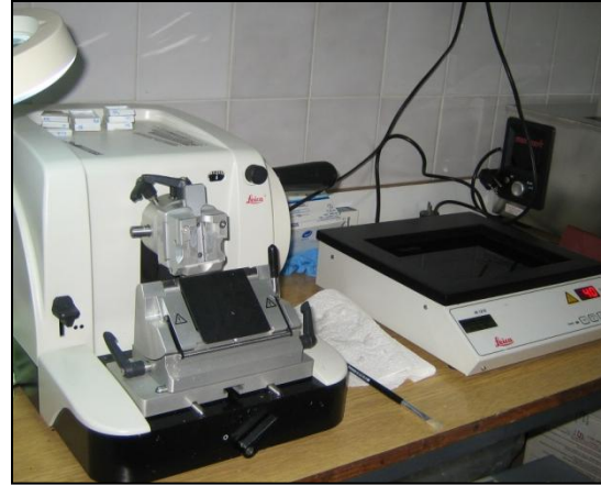
Слика 9. Диспензер за парафин са топлом и хладном плочом (Leica EG1150H, Leica EG1150C, Microsystems, Germany) (лево) и ротациони микротом (Leica RM2125RT, Microsystems, Germany) (десно).
