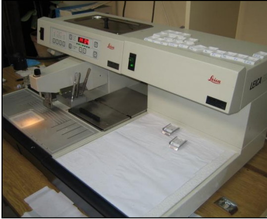
Слика 9. Диспензер за парафин са топлом и хладном плочом (Leica EG1150H, Leica EG1150C, Microsystems, Germany) (лево) и ротациони микротом (Leica RM2125RT, Microsystems, Germany) (десно).
