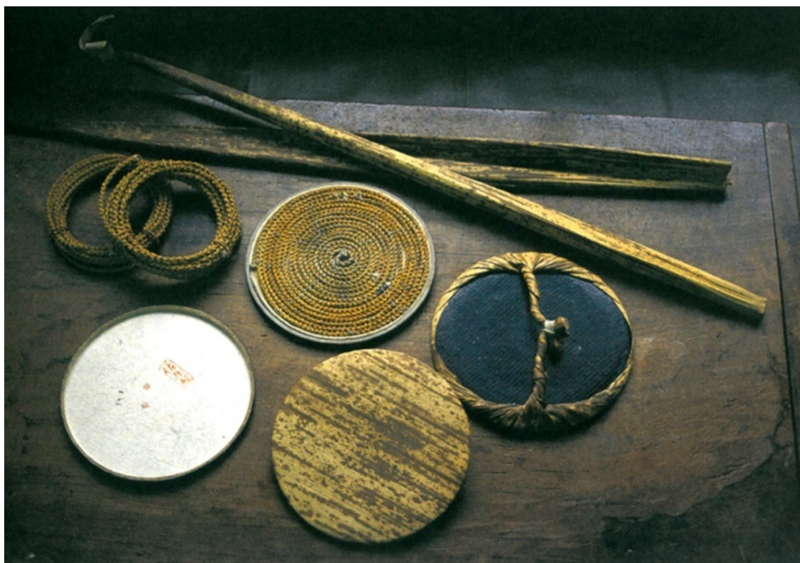
Традиционални диск барен израђен од бамбуса Делови барена: трака – tsuna , диск – ategawa , омот диска – barengawa
