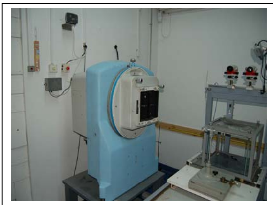
Slika 3.3. Etalonsko polje gama zračenja Co-60 IRPIK-B.
