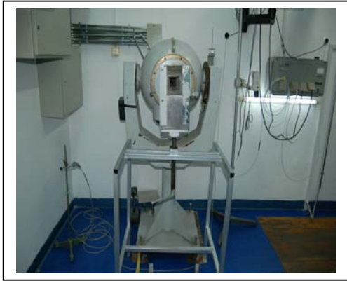
Slika 3.1. Etalonsko polje gama zračenja Co-60 IRPIK-C.
