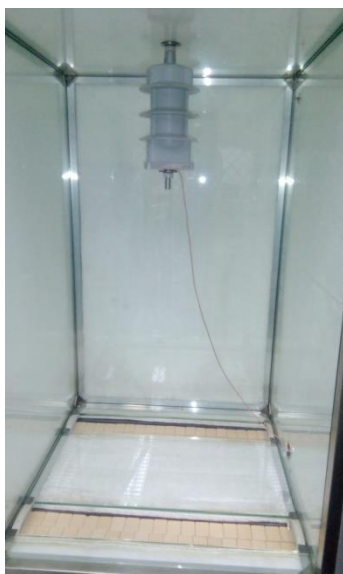
Сл. П5.1 Фотографија коморе за загревање са одводником пренапона
