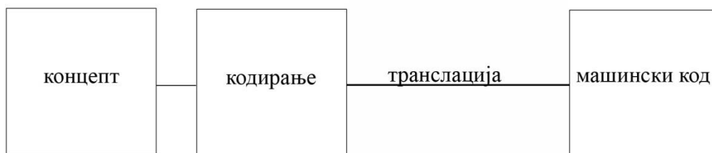
Слика 19: Транслација кода – релација концепт – кодирање – машински код
