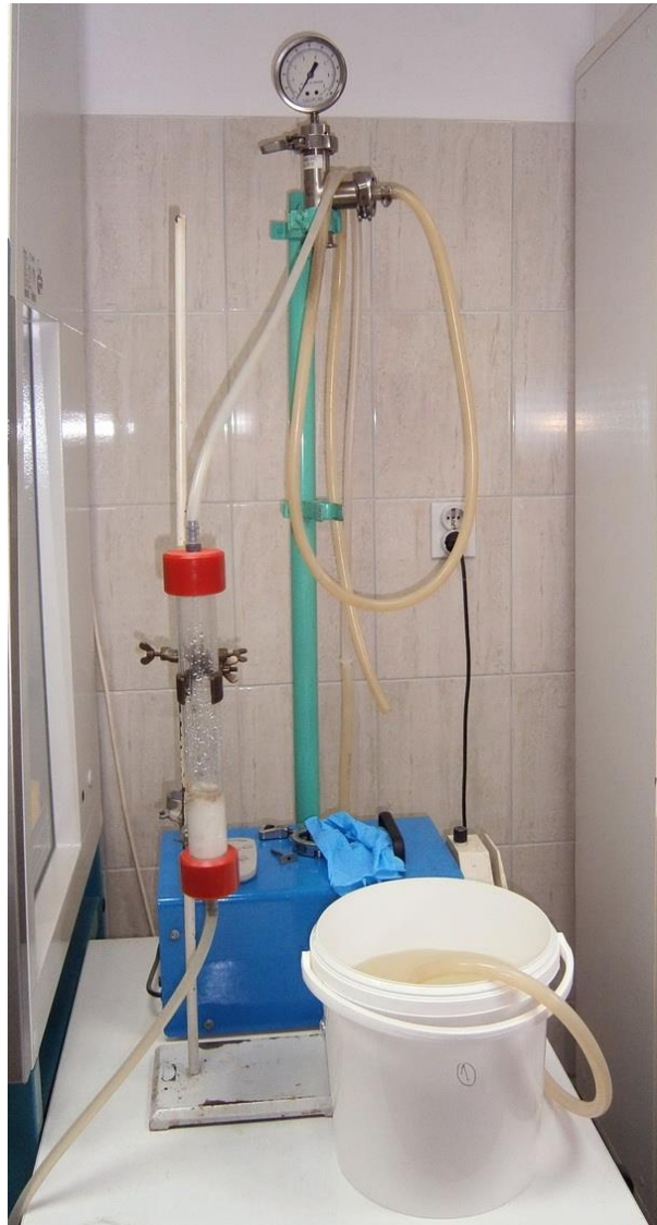
Slika 48. Koncentrovanje virusa iz uzorka vode
