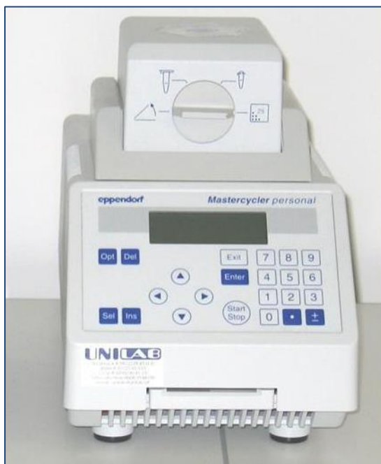
Slika 3-1. Uređaj za PCR dijagnostiku HSV Virusološke laboratorije Instituta za mikrobiologiju Medicinskog fakulteta u Beogradu
