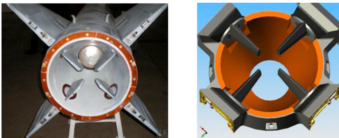
Слика 1.2 Млазна крилца смештена унутар млазника [4] и млазна крилца са шарнирном осом на излазу из млазника [5]
