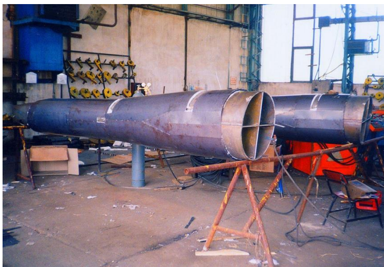
Слика 1.3 Канал кружног попречног пресека концепције ЦГ пре уградње на блоку А1 термоелектране ТЕНТ А
