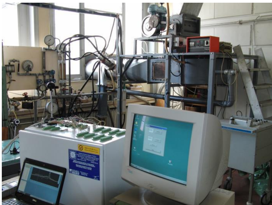
Слика 1.6 Експериментално плазматронско постројење са рачунарским системом за управљање и аквизиционим системом за мерење температура и притисака у каналу
