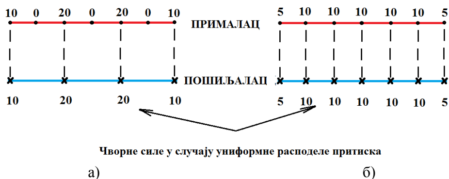
Слика 4.3.6 Дебаланс у преносу притисног оптерећења коришћењем модела MP2 за случај F_{gm}^F = F_{gm}^S када је структурални домен дискретизован елементима вишег реда
