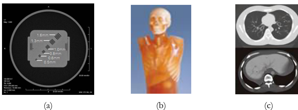
Slika 2.2.12: Test objekti i fantomi za ocenu kvaliteta slike u KT dijagnostici: (a) objekat za ocenu rezolucije visokog kontrasta, (b) fantom sa anatomskim strukturama i (c) KT slike preseka fantoma prikazanog na slici (b).
