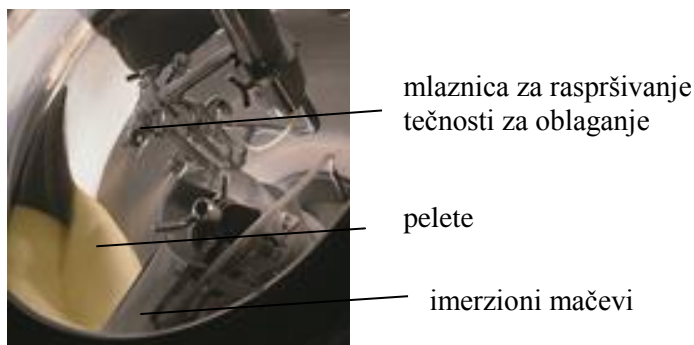
Slika 6. Oblaganje peleta rastvorima i suspenzijama u konvencionalnom uređaju za oblaganje sa imerzionim mačevima (IMA, 2016) Figure 6. Spray coating of pellets in a conventional coating machine with immersion swords (IMA, 2016)
