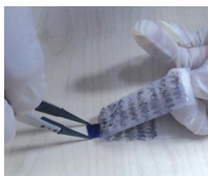
Slika 2.7. Mehanička eksfolijacija metodom lepljive trake kojom se iz grafita dobijaju pojedinačni slojevi grafena.
