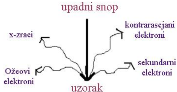
Slika 5.7. Posle interakcije elektrona sa površinom uzorka, dolazi do emisije sekundarnih elektrona, kontrarasejanih elektrona, x-zraka i Oževnih elektrona iz materijala uzorka.
