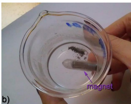
Slika 7.5. a) Crne Ni žice posle oslobađanja od filtera; b) pod uticajem magneta, moguće je kontrolisati niklene nanožice.
