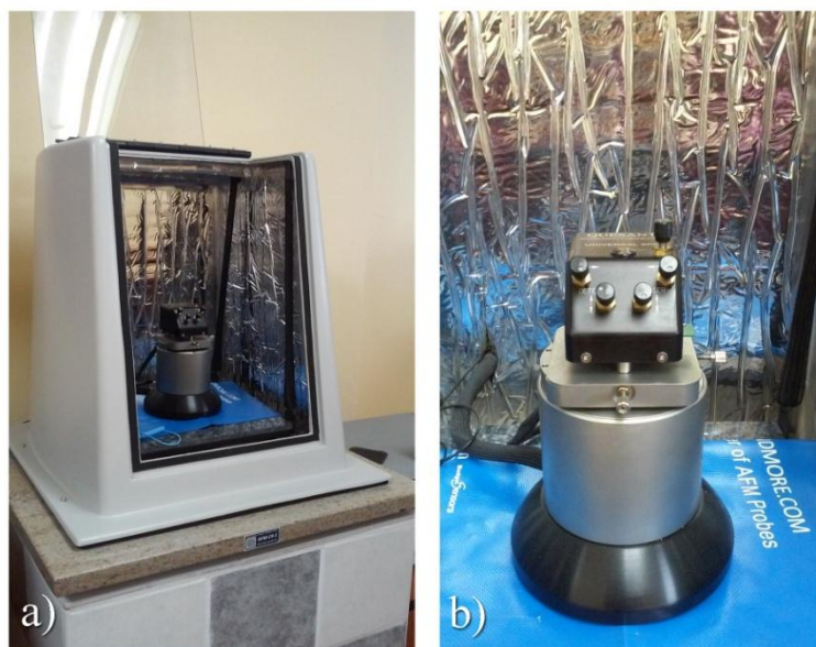
Slika 7.10. Quesant/Ambios AFM uređaj na kome su vršena snimanja u Laboratoriji za radijacionu fiziku i hemiju u Institutu za nuklearne nauke „Vinča“: a) uređaj je u specijalnoj komori koja štiti instrument od akustičnih vibracija; b) i nalazi se na podlozi koja sprečava stvaranje statičkog elektriciteta.
