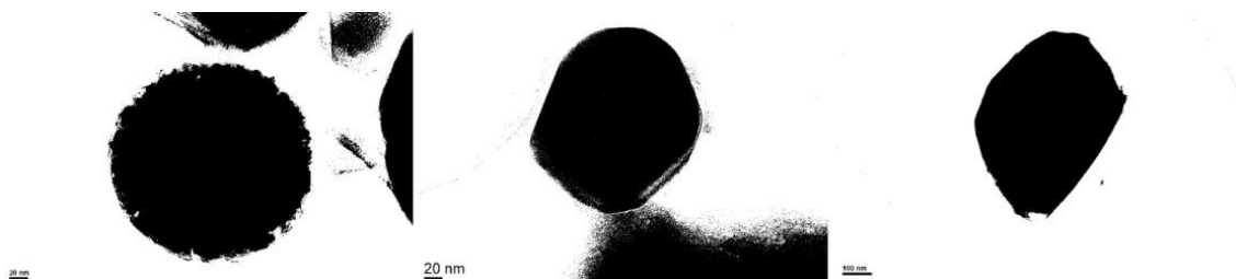
Slika 5.3. Binarne mikroskopske slike hematita dobijene segmentacijom pomoću praga
