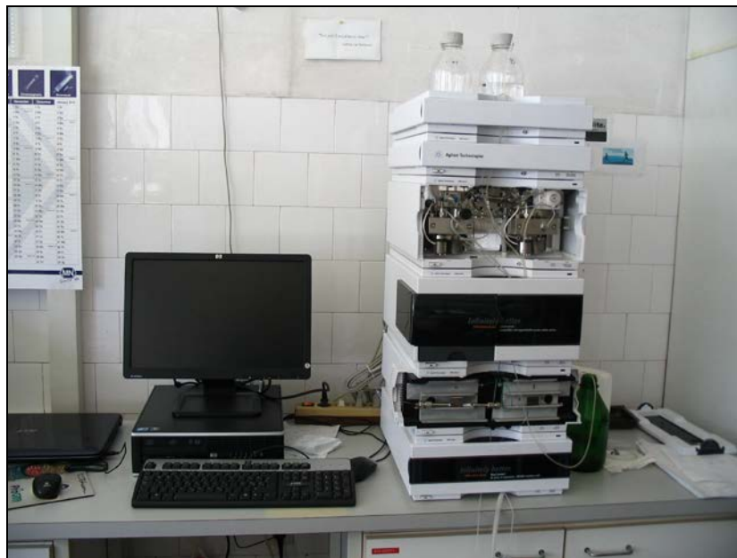
Slika 9. HPLC sistem za identifikaciju i kvantifikaciju individualnih fenolnih jedinjenja u plodu kupine
