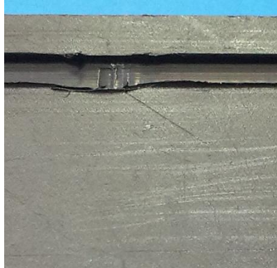
Slika 73. Uvećani prikaz udubljenja u predmetu rada nastalog procesom rezanja
