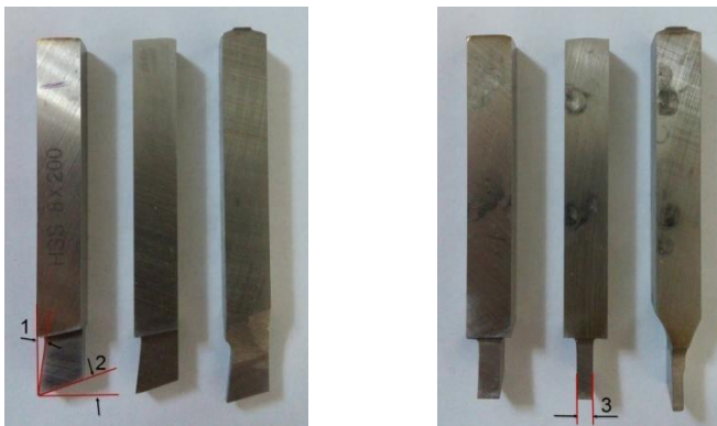
Slika 32. Izrađeni noževi za rendisanje
