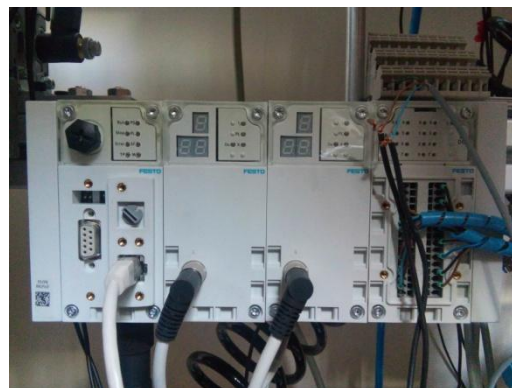
Slika 26. CPX terminal za upravljanje pneumatskim osama
