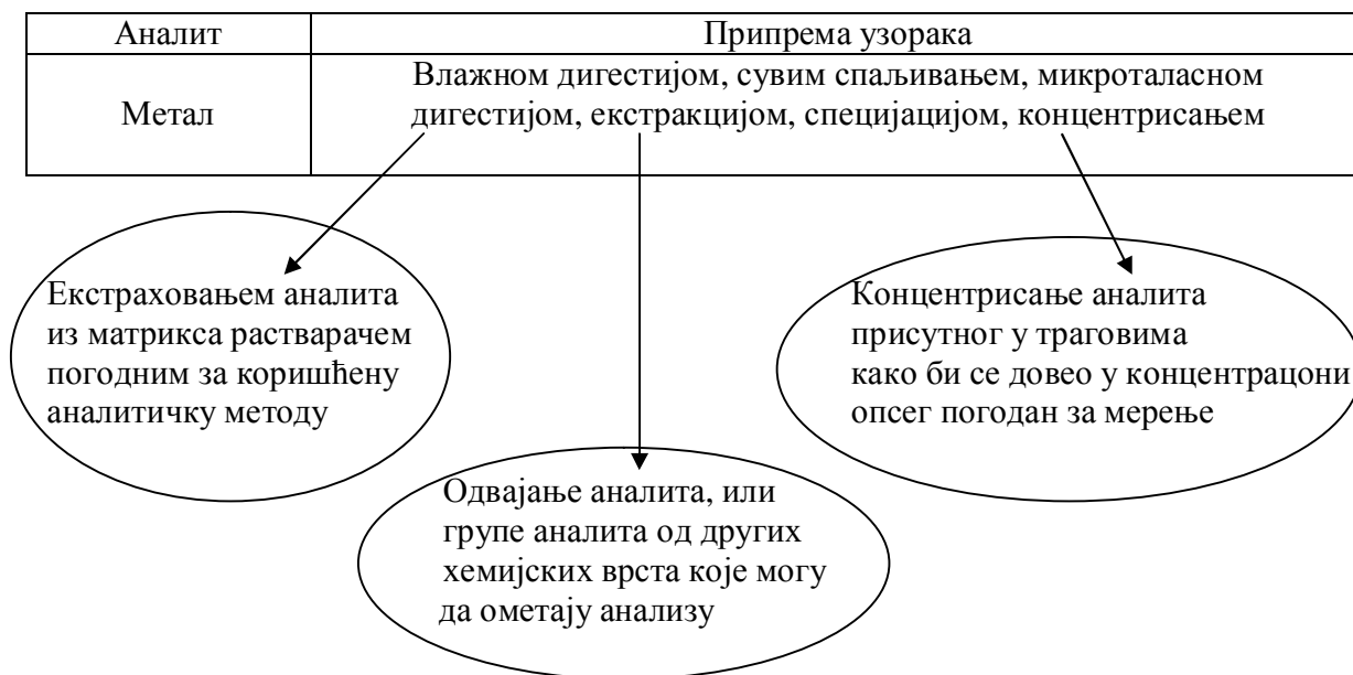
Слика 3.6. Шематски приказ начина ослобађања метала из узорака
