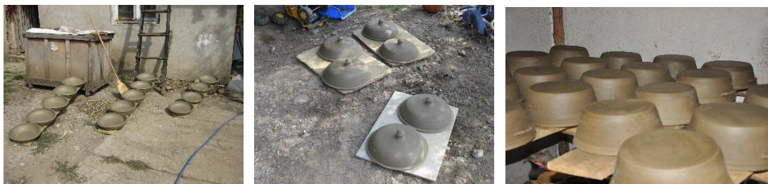
Сл. 38. Сушење посуда на отвореном и у затвореном простору, Велики Суводол
