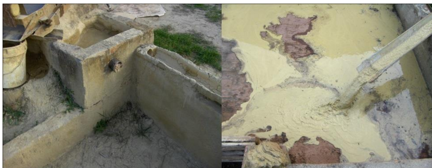
Сл. 14. Систем филтера и базена за пречишћавање глине (Padilla 2014)
