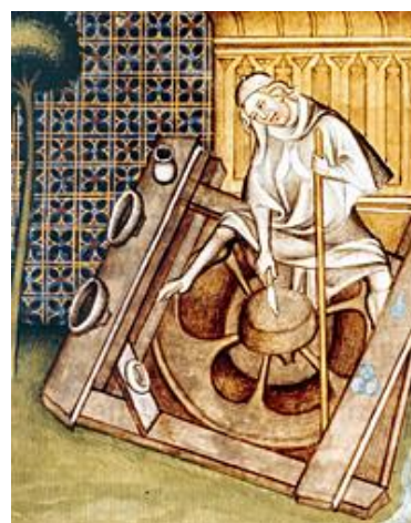
Сл. 34. Витло на погон штапом (© BNF M. fr. 235, f o 158v o ; Ms.fr. 22912, f o 227 v o )
