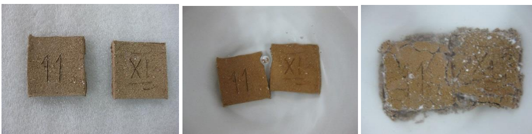
Сл. 109. Узорци бр. 11 и XI, температура печења 1150°C
