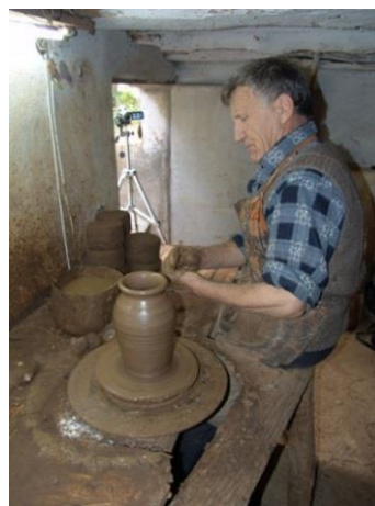
Сл. 18. (1) Ручна израда посуда (Sempere 1982); (2) Градња намотајима на ручном витлу, Злакуса; (3) Моделовање на ножном витлу, Шапранце код Трговишта
