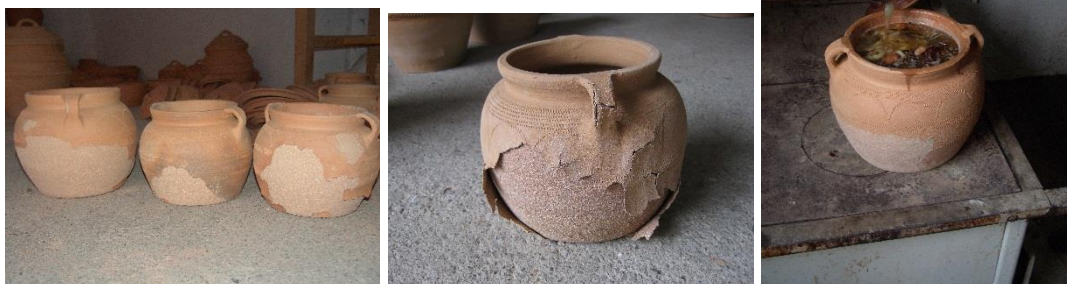
Сл. 78. Љуспање лонаца услед печења на температури већој од оптималне
