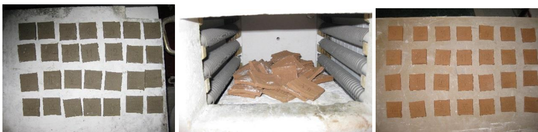
Сл. 100. Узорци пре печења и после првог печења на 600°C
