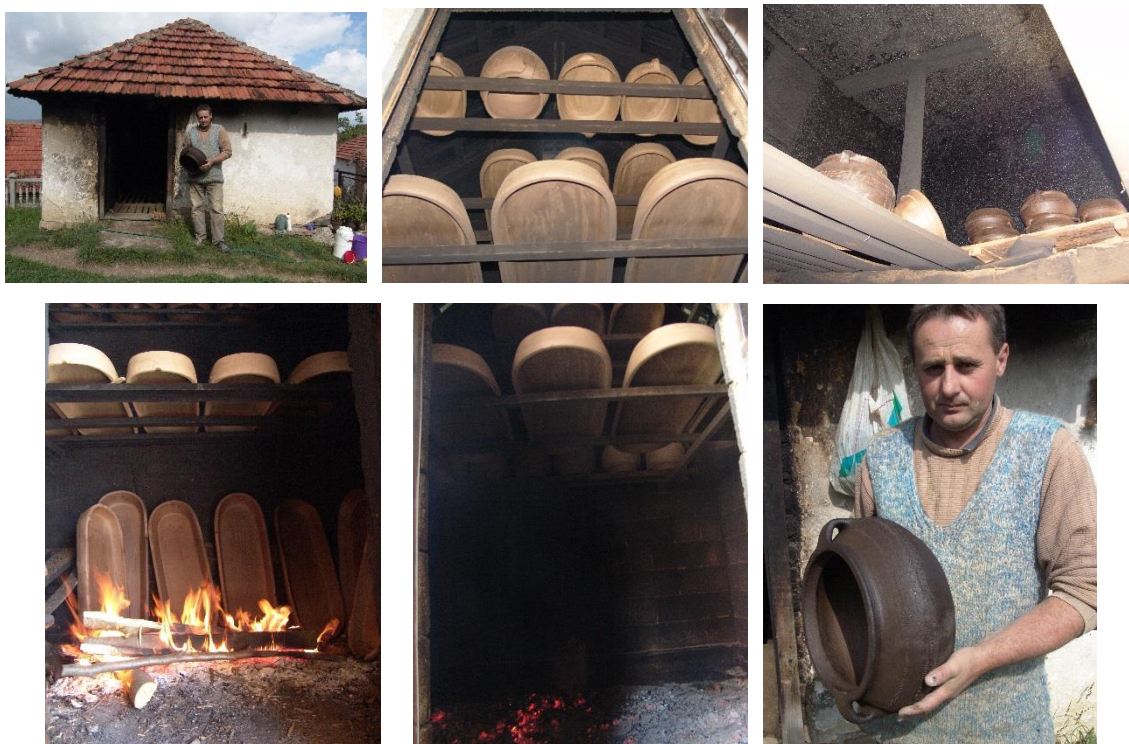
Сл. 74. Сушара, сушење у сушари и изглед лонца после сушења у сушари
