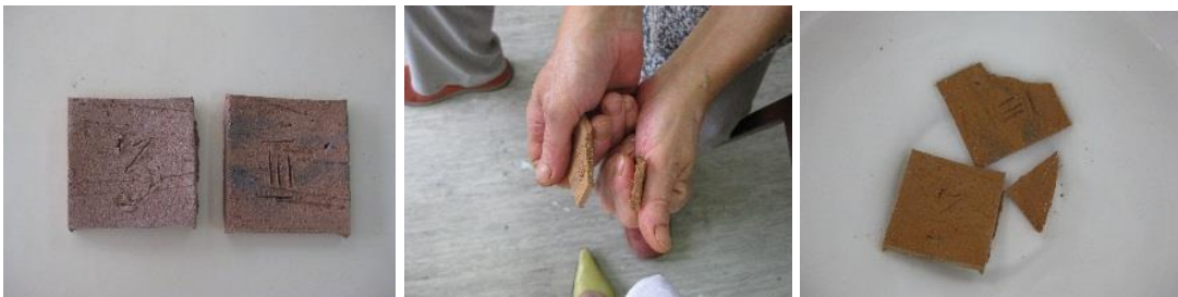
Сл. 104. Узорци бр. 3 и III, температура печења 700°C
