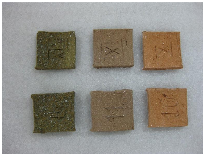
Сл. 101. Различите боје печења у зависности од температуре
