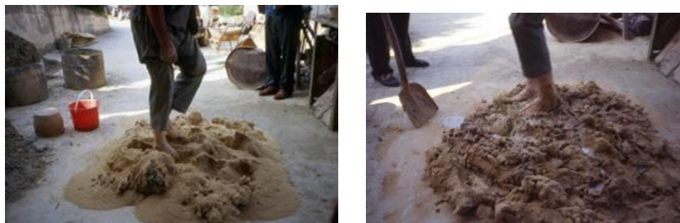
Сл. 61. Гажење глине и самлевоног калцита
