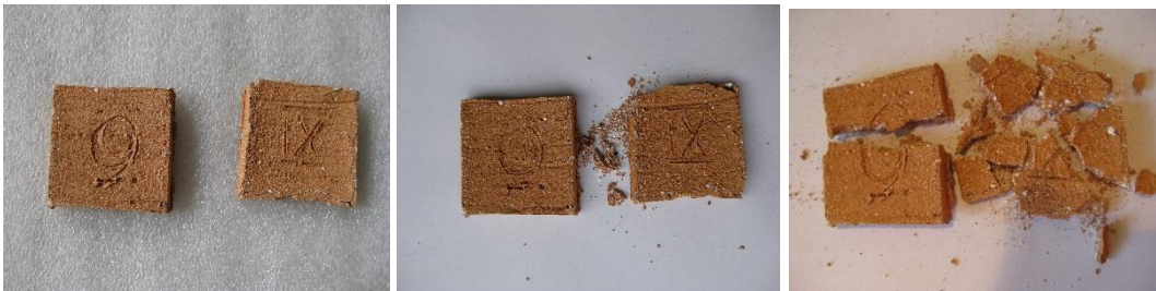
Сл. 107. Узорци бр. 9 и IX, температура печења 950°C
