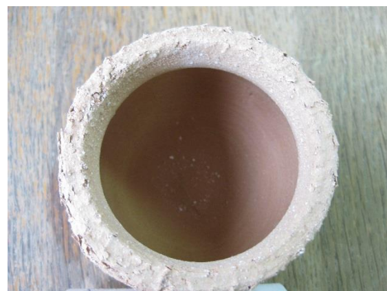
Сл. 115. Модел печен на 825°C – спољашна страна и унутрашњост
