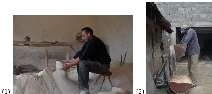
Сл. 60. (1) Просејавање и (2) машинско млевење врсте
