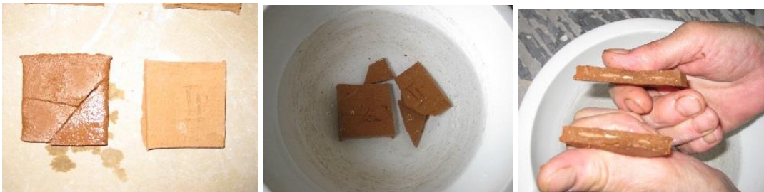
Сл. 103. Узорци бр. 2 и II, температура печења 650°C
