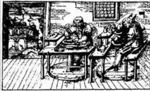
Сл. 35. Витло на ножни погон (Piccolpasso 1857: Tav 10/Fig 38, Tav 12/Fig 46)
