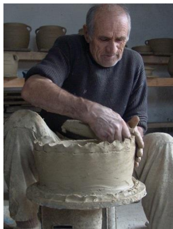
Сл. 18. (1) Ручна израда посуда (Sempere 1982); (2) Градња намотајима на ручном витлу, Злакуса; (3) Моделовање на ножном витлу, Шапранце код Трговишта
