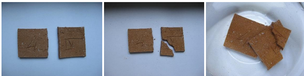
Сл. 105. Узорци бр. 4 и IV, температура печења 735°C
