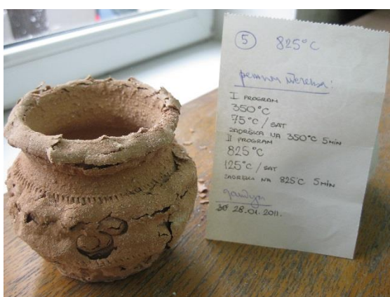
Сл. 115. Модел печен на 825°C – спољашна страна и унутрашњост
