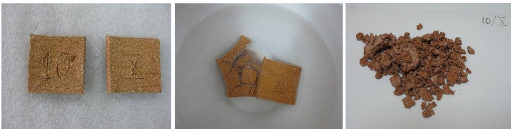
Сл. 108. Узорци бр. 10 и X, температура печења 1000°C
