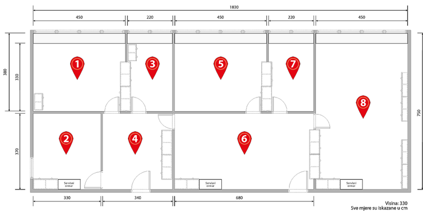
Slika 5.2.1.1.1. Tlocrt poslovnog objekta odabranog za mjerenje parametara životne sredine u zatvorenom prostoru
