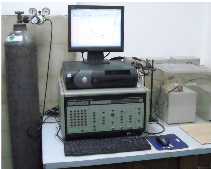
Slika 3.1: Sistem na kome su rađeni elektrohemijski eksperimenti argon boca, potenciostat 273A sa kompjuterom za kontrolu i peč sa ćelijom.
