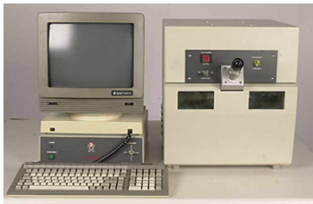
Slika 6.2.15.1 Aparat za merenje debljine prevlaka Fluoderm XRF-200
