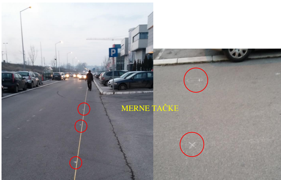
Slika 62. Obeležavanje mernih tačaka za merenje nivoa osvetljenosti u polju vrednovanja
