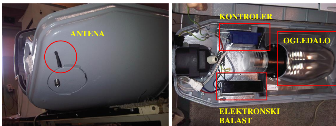
Slika 42. Položaj antene i električno kolo svetiljke ONYX 2
