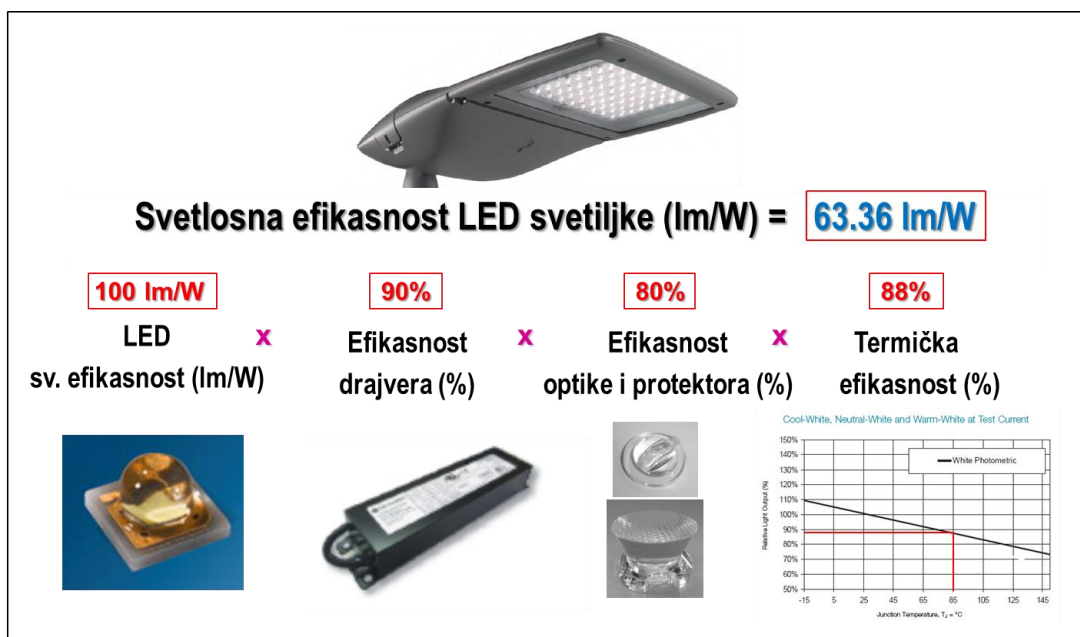
Slika 31. Svetlosna efikasnost LED svetiljke kao integrisanog sistema 19
