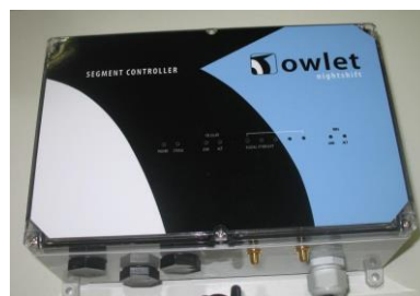
Slika 52. Segmentni kontroler OWLET sistema
