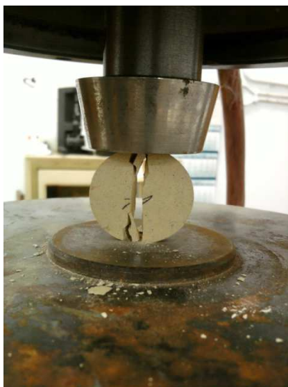
Слика 43. Приказ лома узорка при одређивању затезне чврстоће узорка
