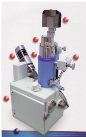
Слика 19 SEM модел: JOEL JSM-6610LV (1-јонска пумпа, 2-електронски топ, 3-колона, 4-EDS детектор 5- CL детектор, 6-комора за узорке)
