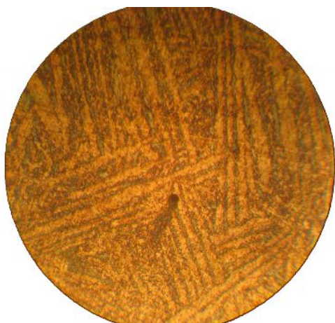
Слика 36 Микроструктура легуре SnZn10Bi10 (оптичка микроскопија)
