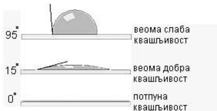
Слика 3 Изглед капи при различитом додирном углу
