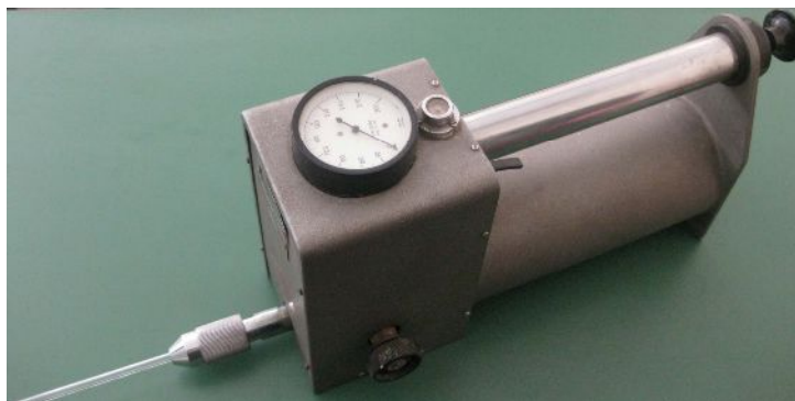
Слика 24 Ручна вакум пумпа са кварцном цевчицом
