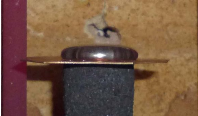
Слика 80 Формирана кап узорка легуре SnZn10Sb10 у електроотпорној пећи
