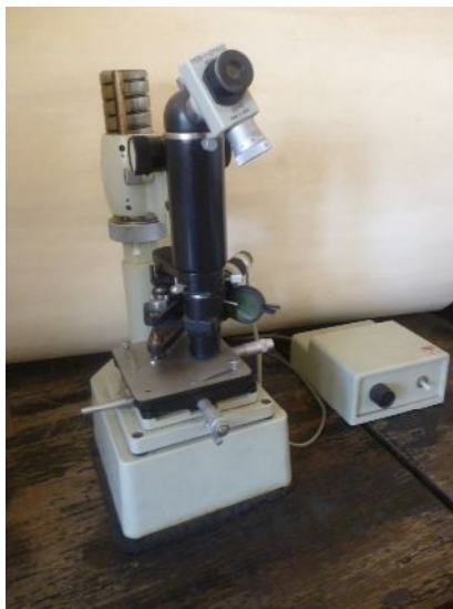
Слика 22 Апарат за мерење микротврдоће
