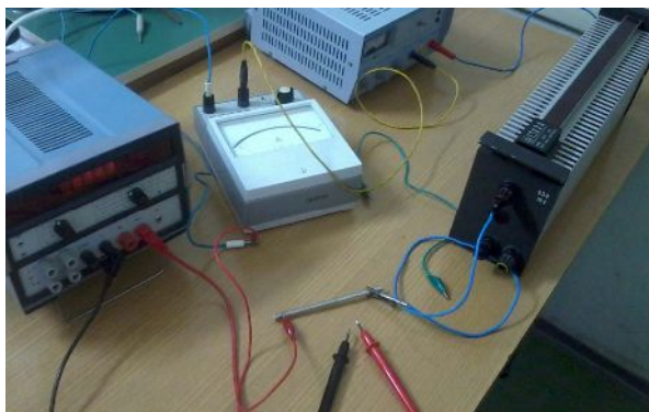
Слика 26 Апаратура за мерење електропроводљивости методом Винстоновог моста
