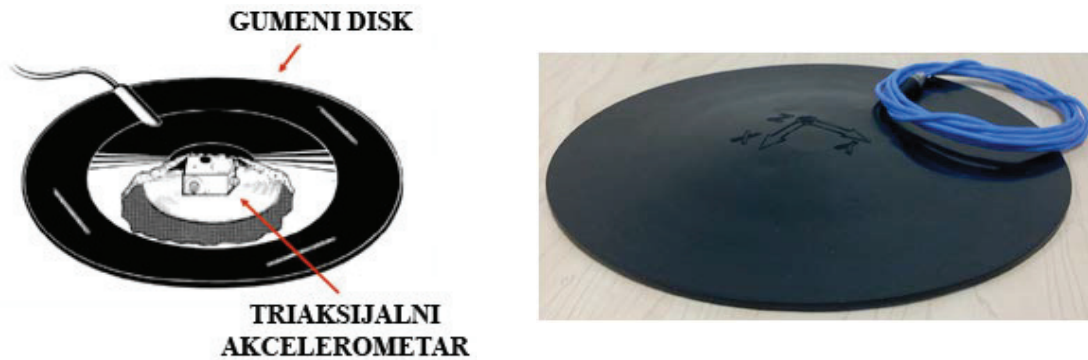
Slika 4.10. Triaksijalni akcelometar u gumenoj podlošci
