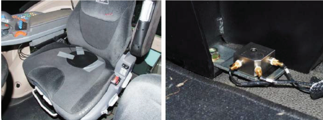
Slika 4.12. Mesta postavljanja senzora na sedištu i podu vozila
