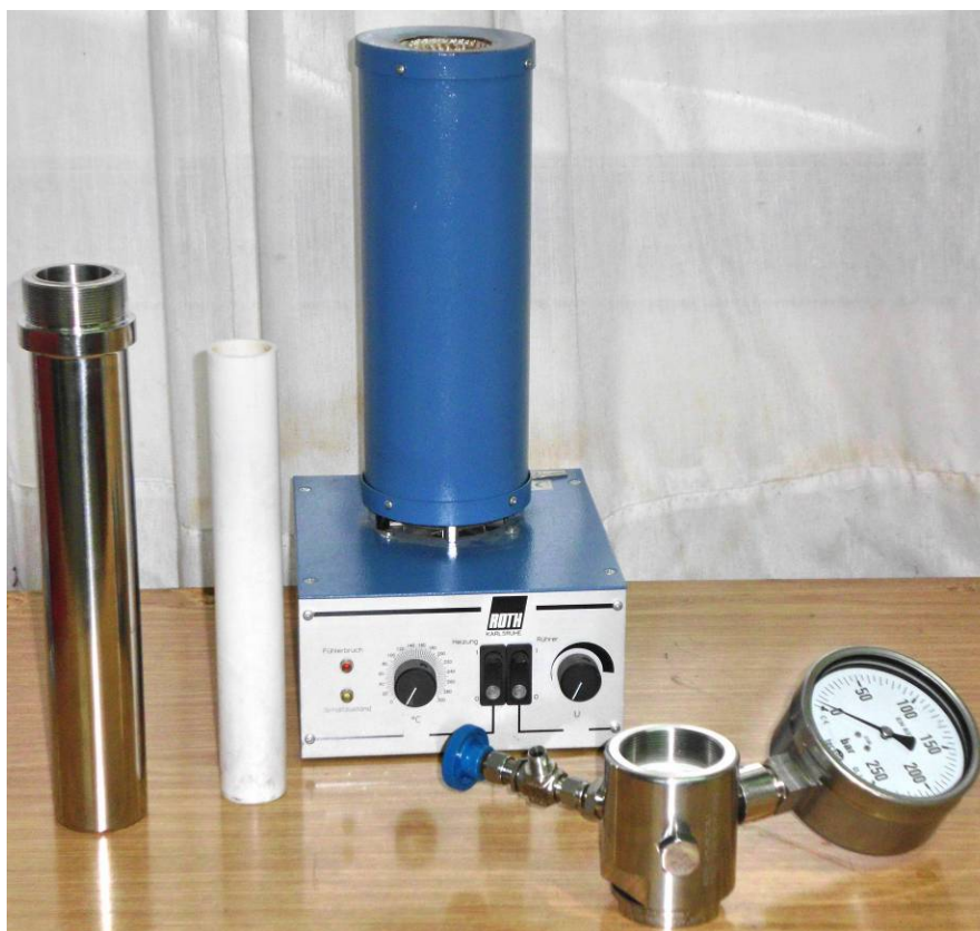
Slika 2.3. Autoklav ( Roth Karlsruhe , T_{max} = 300\text{ }^{\circ}\text{C} , p_{max} = 300\text{ bar} ) u laboratoriji Instituta za multidisciplinarna istraživanja.
