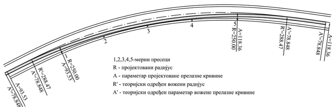
Слика 5.33 Теоријски одређена гранична вожена трајекторија за мерно место 1
