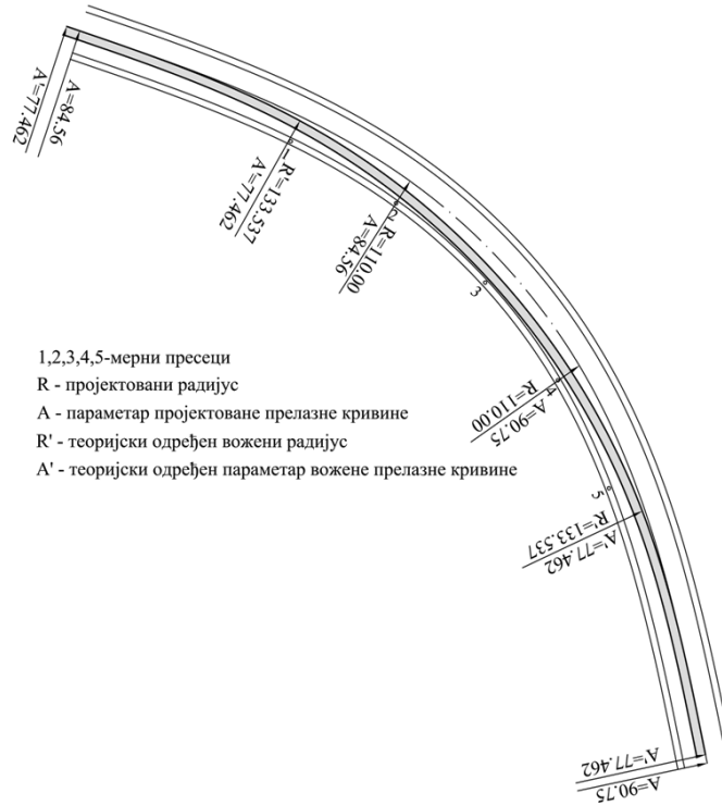
Слика 5.49 Теоријски одређена гранична вожена трајекторија за мерно место 3
