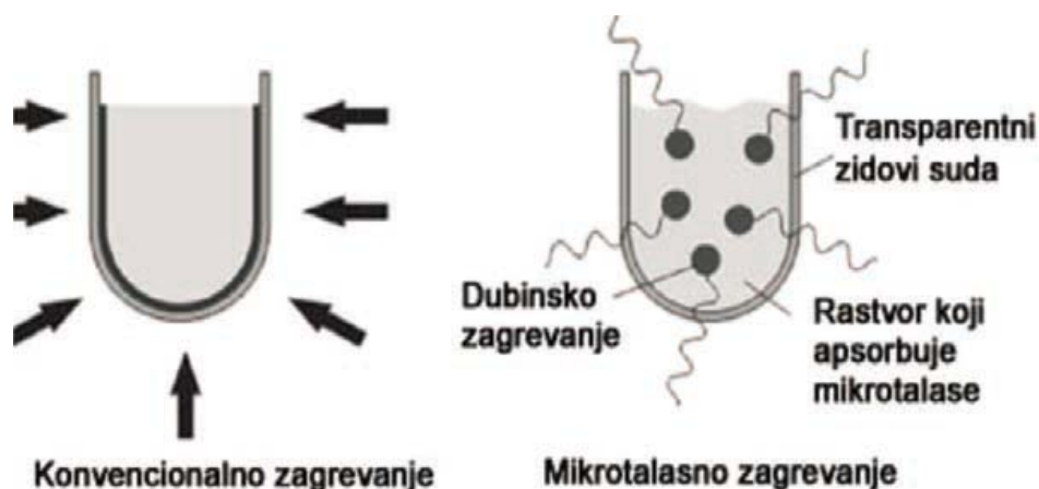
Slika 26. Diferencijalno zagrevanje pri klasičnom i mikrotalasnom zagrevanju.
