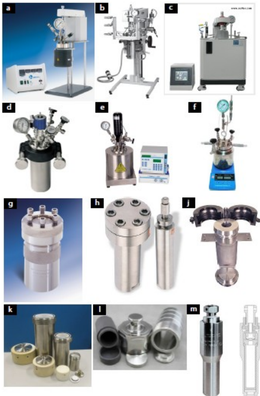
Slika 3.1. Uredaji za šaržnu hidrotermalnu i solvotermalnu sintezu, koji se mogu naći na tržištu, od različitih proizvođača, različitih opsega maksimalnih pritiska i temperatura od 200 °C i 3MPa pa do 600 °C i 70 MPa: „floor stand“ reaktorski sistemi a) SAD Parr i b) Autoclave Engineers, c) Južno Korejski Il Shin Autoclave; „bench top“ reaktorski sistemi d) Nemački Berghof, e) Švajcarski Büchi Glas Uster, f) Kineska Ouman International Industry Co. LTD; autoklavi opšte namene i digestione bombe g) Parr, h) Autoclave Engineers, j) Il Shin, k) Orbit Research Associates, l) Ouman Int. Ind. Co., m) Berghof i drugi.
