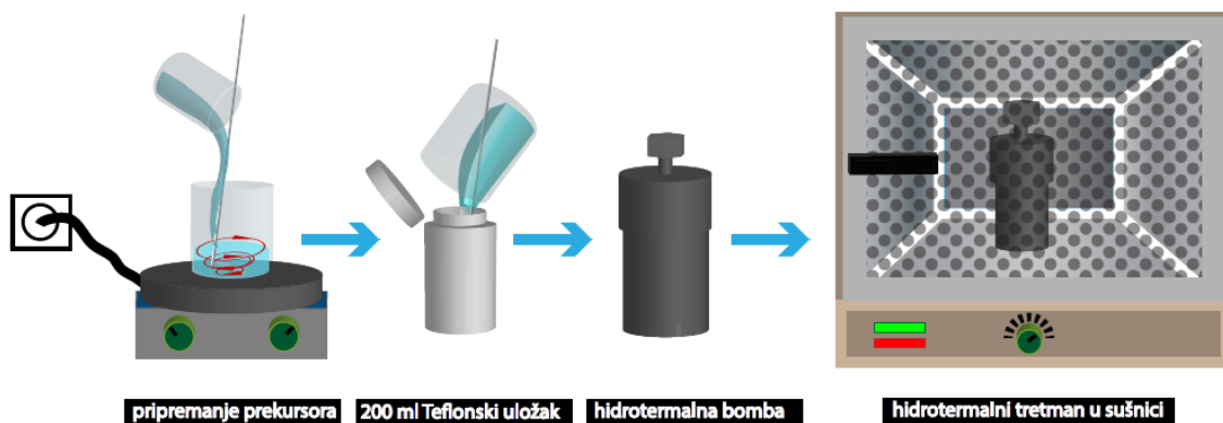
Slika 3.1.2. Postupak sinteze nanočestica hidroksiapatita parcijalno supstituisanog jonima Zr^{4+}
