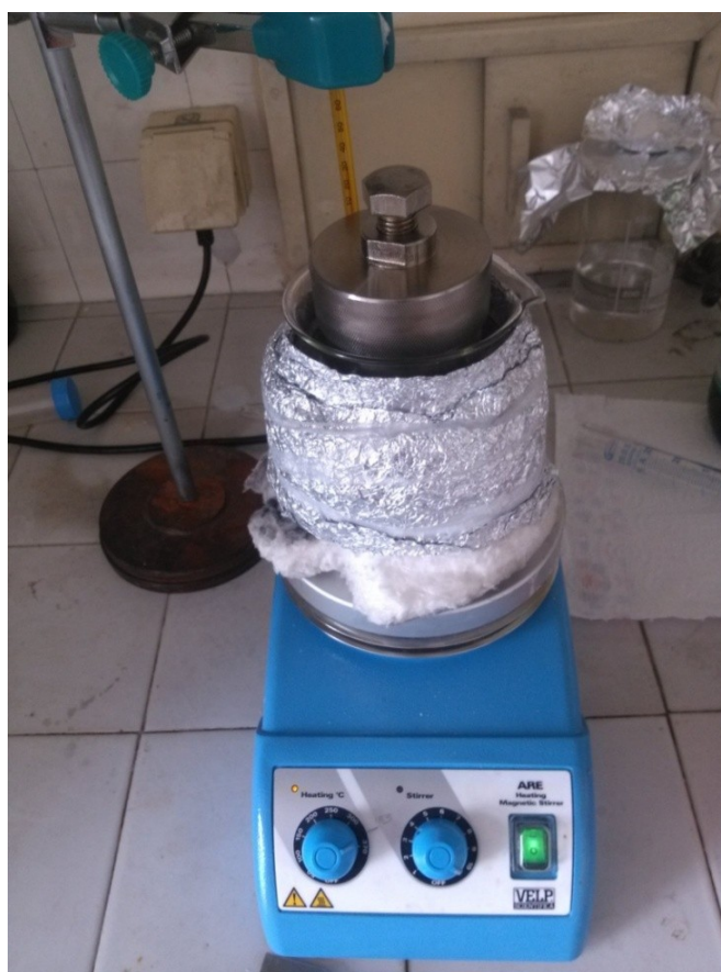
Slika 3.7. Uljano kupatilo za zagrevanje hidrotermalne bombe napravljeno od vatrostalne čaše koja je izolovana staklenom vunom. Maksimalna radna temperatura je 220 °C.
