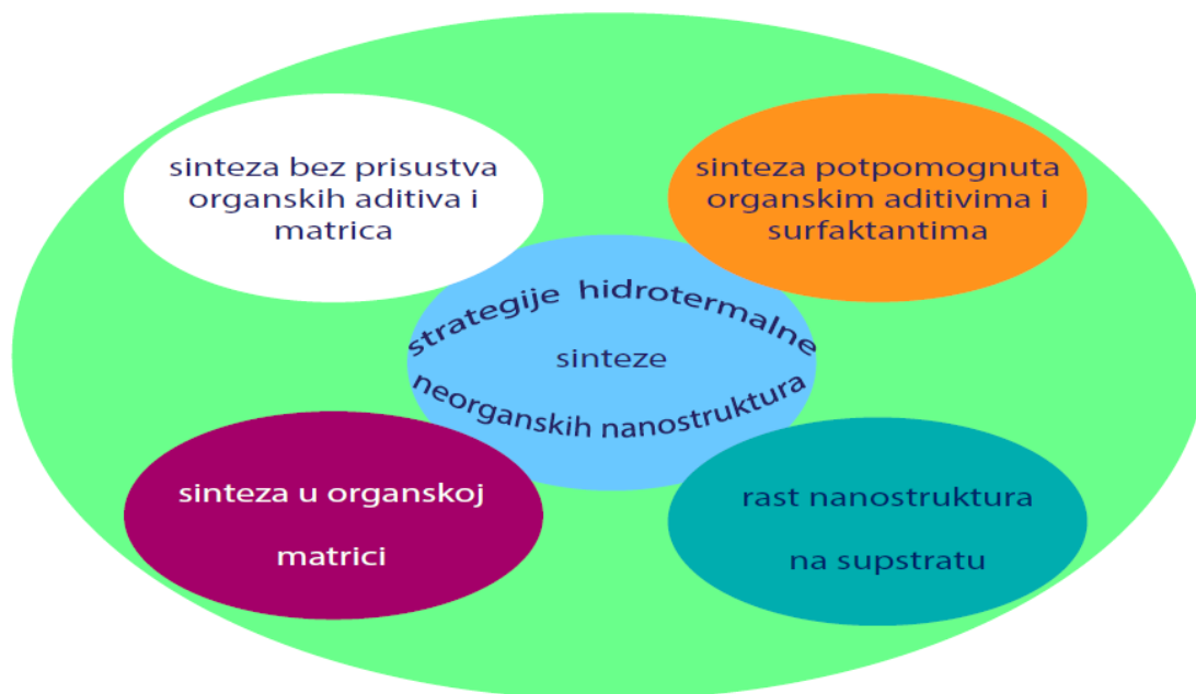
Slika 2.3.1. Podela strategija hidrotermalne sinteze neorganskih nanostrukture na bazi unutrašnjih parametara sistema 20 .
