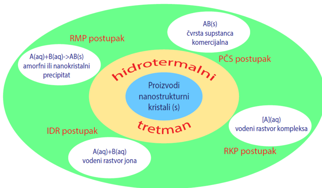
Slika 2.3.2. Šema podele hidrotermalnih postupaka koji ne koriste organske aditive i matrice kao sredstva u sintezi nanosturktura 20 .
