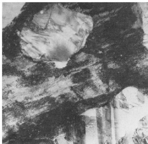
Slika 3.1 TEM mikrofotografija delimično rekristalizalog uzorka Cu-8,5mas.%Al ( \epsilon=80\% , T=300^{\circ}\text{C} , t=4\text{h} ); 21625x [9]
