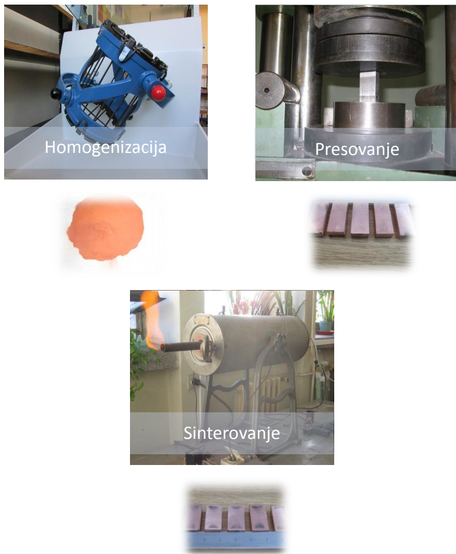
Slika 6.1 Prikaz postupka dobijanja sinterovanih uzoraka
