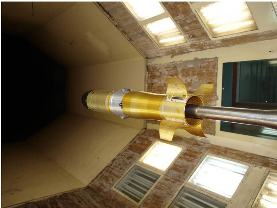
Сл. 57. Модел монтиран на репни држач – угао ваљања 90^\circ
