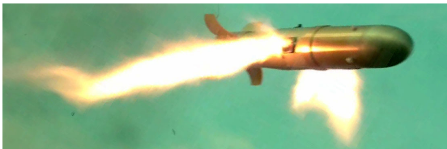
Сл. 153. ПТВР са системом УВП на принципу урањања интерцептора у млаз
