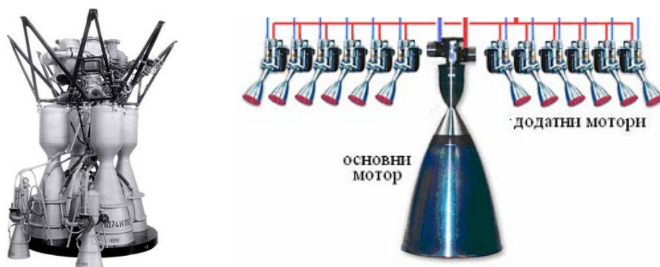
Сл. 14. Системи за УВП са додатним моторима, покретним – лево и фиксним моторима променљивог потиска – десно
