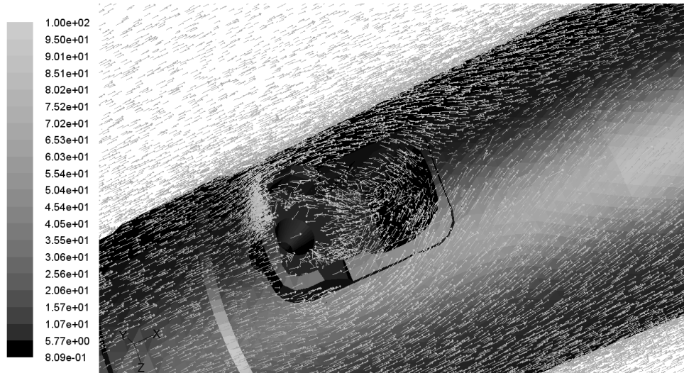
Сл. 145. Вектори брзине струјања ваздуха у интеракцији са геометријом ракете и млазом продуката сагоревања
