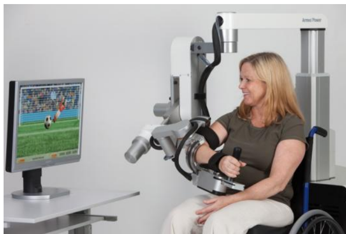
Slika 1.10. Uređaj ArmeoPower (Hocoma, Švajcarska), komercijalna verzija ARMin uređaja (ETH Cirihi, Švajcarska).
