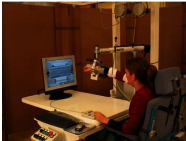
Slika 1.12. Rehabilitacioni robotski sistem GENTLEs, zasnovan na Haptic Master platformi
