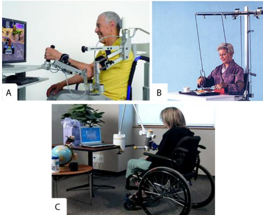
Slika 1.6. Pasivni robotski sistemi za rehabilitaciju gornjih ekstremiteta. A) Armeo Spring, Hocoma, Švajcarska; B) Swedish Helparm, Kinsman Enterprises, Švedska; C) ReJoyce, Univerzitet Alberta, Kanada.
