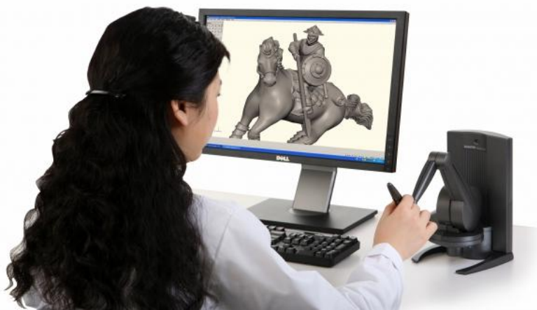
Slika 1.16. Vajanje 3D modela pomoću haptičkog uređaja. Preuzeto sa sajta firme SensAble Technologies.
