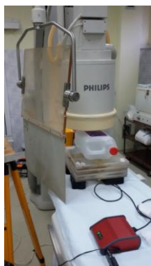
Slika 57. Rendgen-aparat za interventne procedure: PA orijentacija cevi
