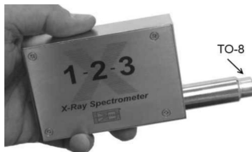
Slika 33. Izgled AMPTEK X-123CdTe spektrometra (Prava zadržava Amptek Inc.)
