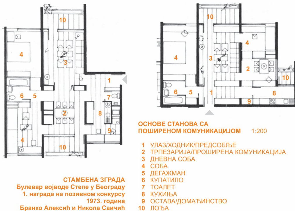
Слика 1.1.3. Карактеристичне основе два "београдска стана" са проширеном комуникацијом, 1973. година. Станови обилују кружним везама. Извор: Архитектура и урбанизам, број 74-77 (1975), пример 14.0. (илустрације су прилагођене за потребе овог истраживања)
