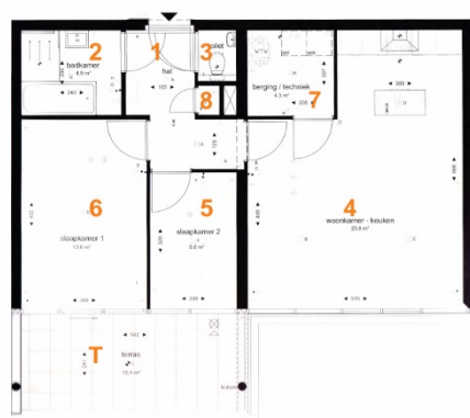
Слика 3.1.2.2. Основа трособног стана у стамбено-пословном комплексу 100hoog, Wijnstraat, Rotterdam, 1:200, са прегледом просторија, архитекта: Klunder architecten; размера 1:200. Извор: Port au Vin C.V., (ed.), 100 hoog Rotterdam, Wijnhavenkwartier, 2010, (57), Rotterdam.
