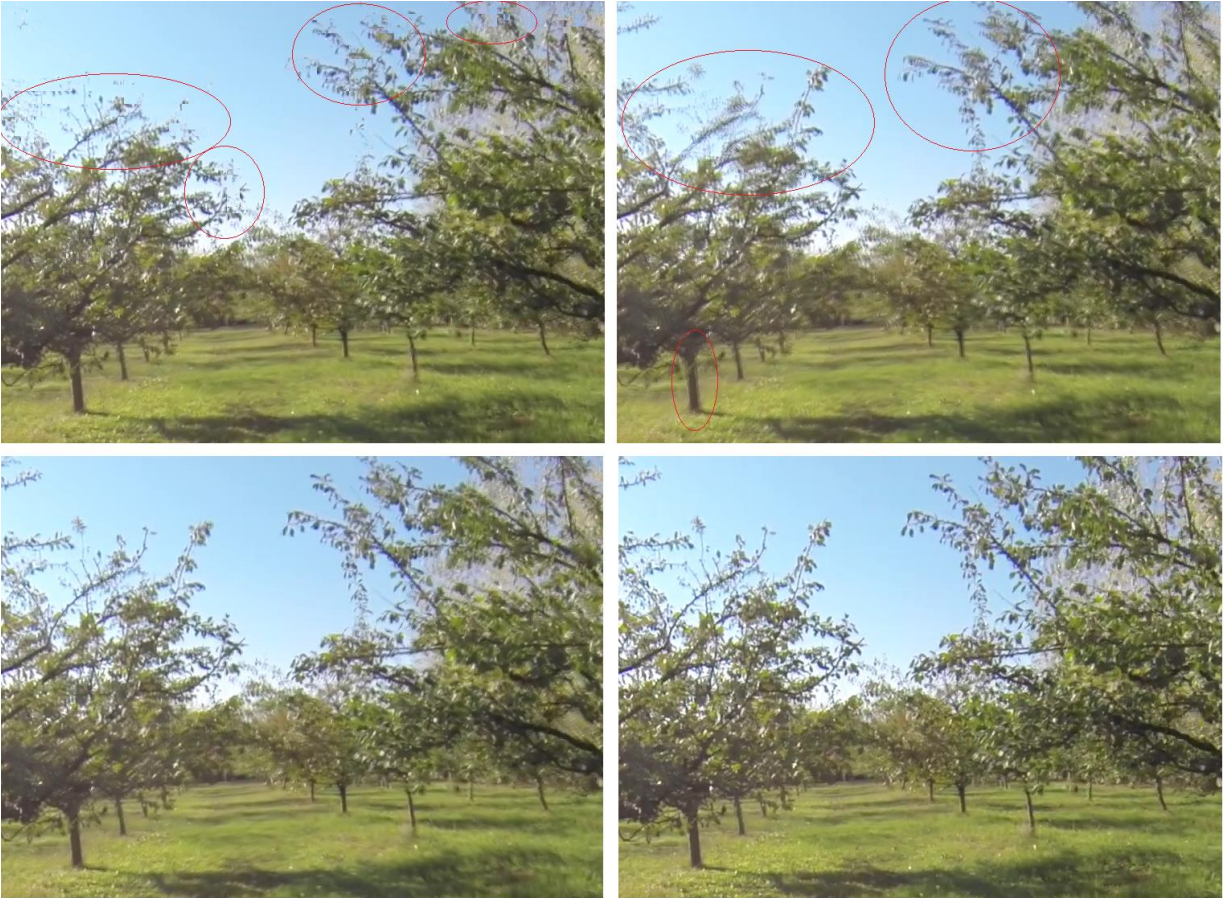
Слика 4-2: Визуелно поређење интерполираних фрејмова видео секвенце Fruit yard , креираних алгоритмом за повећање броја слика у секунди у видео секвенцама користећи различите методе за естимацију кретања: горе-лево - FS , горе-десно - 3DRS , доле-лево - БМК, доле-десно - оригинални фрејм. Артефакти настали усред погрешне или недовољно прецизне естимације су заокружени црвеном бојом.
