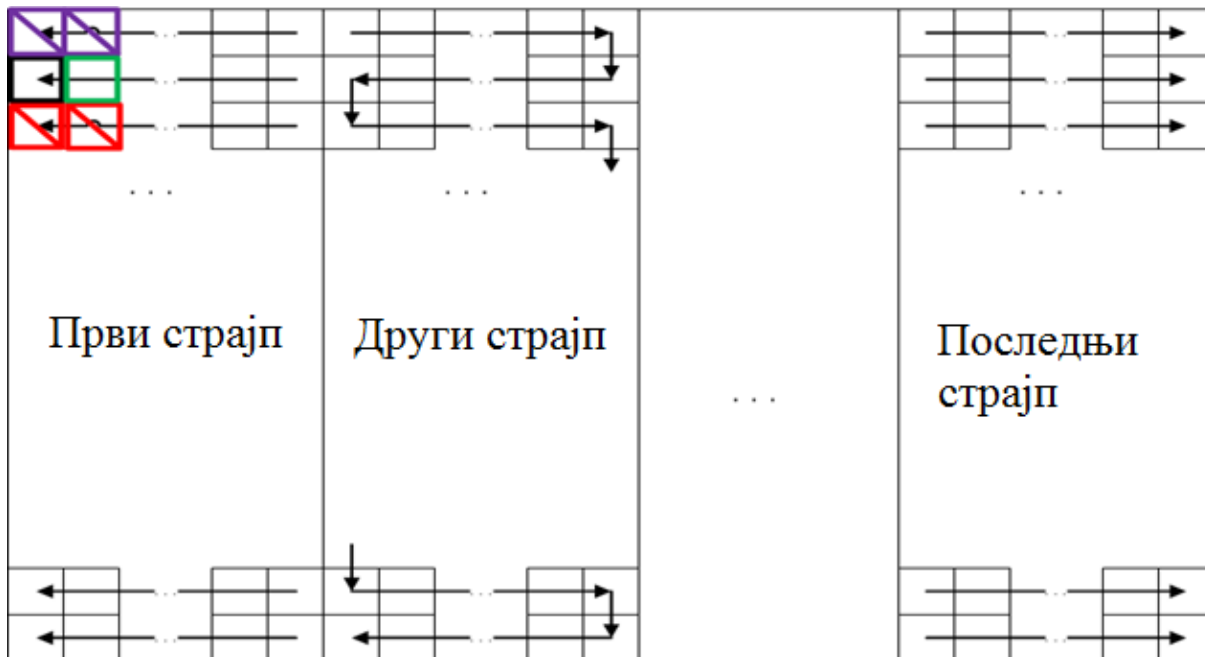
Слика 3-12: Смер процесирања (скенирања) блокова у фрејму. Фрејм је подељен на одређени број вертикалних целина – страјпова. Блокови се процесирају од горе ка доле, пратећи назначене стрелице. Такав редослед процесирања блокова омогућава доделу стварних вектора помераја ивичним блоковима. Вектор кандидат блока означеним зеленом бојом је просторни кандидат за назначени ивични блок. Вектор кандидати за блокове означене црвеном бојом још увек нису срачунати. Вектори са блокова означених љубичастом бојом такође нису подобни као кандидати за ивичне векторе помераја.
