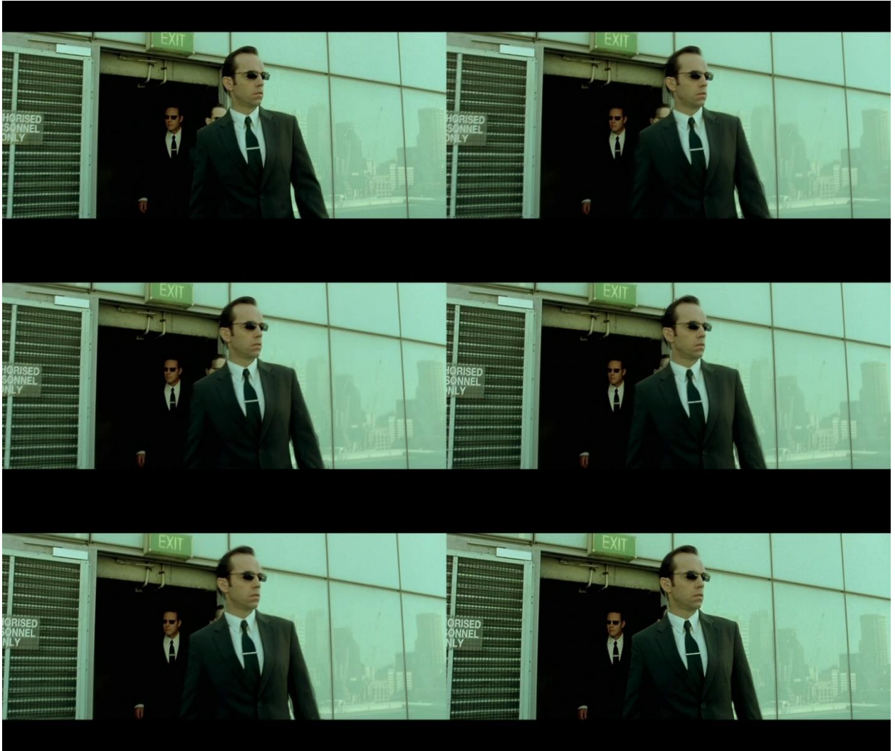
Слика 4-15: Два оригинална (горе-лево и доле-десно) и четири интерполирана фрејма између њих видео секвенце Matrix , креиран помоћу описаног БМК алгоритма. Оригинални фрејмови видео секвенце су на временским позицијама n и n+2 .
