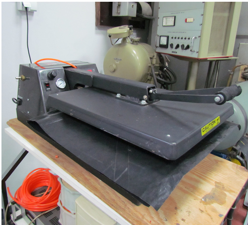
Слика 5.3. Хидрауличка топла преса за припрему узорака
