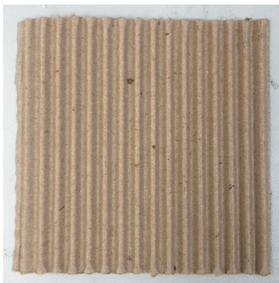
Слика 5.8. Слој ребрестог картона у ЕП-СВ-К композиту
