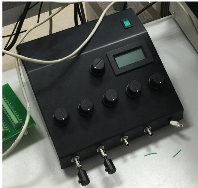
Слика 5.13. Уређај са уграђеним емитерским диодама - светлосни извор
