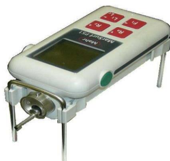
Slika 5.12 Uređaj za merenje hrapavosti obrađene površine „MarSurf PS1“
