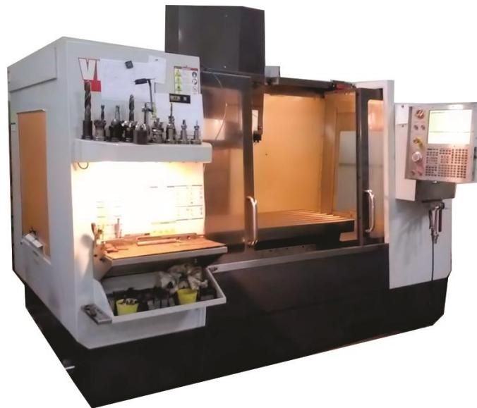
Slika 5.6 CNC vertikalni obradni centar "HAAS" VF-3YT
