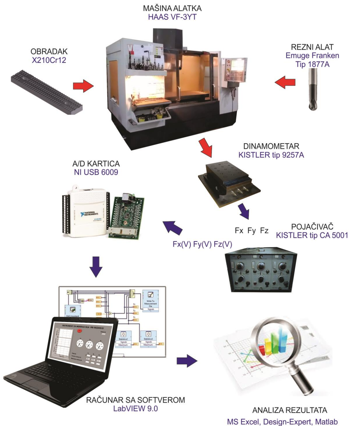
Slika 5.5 Merenje sila rezanja u procesu glodanja vretenastim loptastim glodalom
