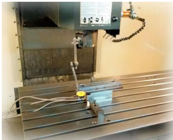
Slika 5.14 Pozicioniranje obratka na CNC vertikalnom obradnom centru
