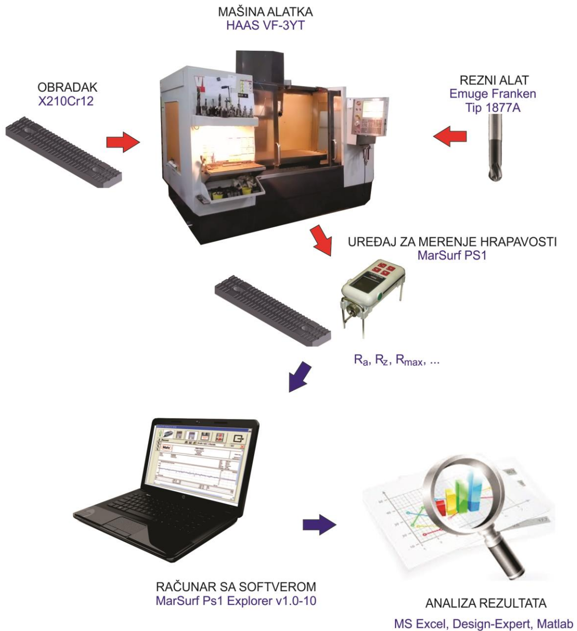
Slika 5.11 Merenje hrapavosti površine obrađene vretenastim loptastim glodalom
