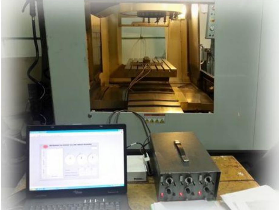
Slika 5.15 Povezivanje merno-akvizicionog sistema
