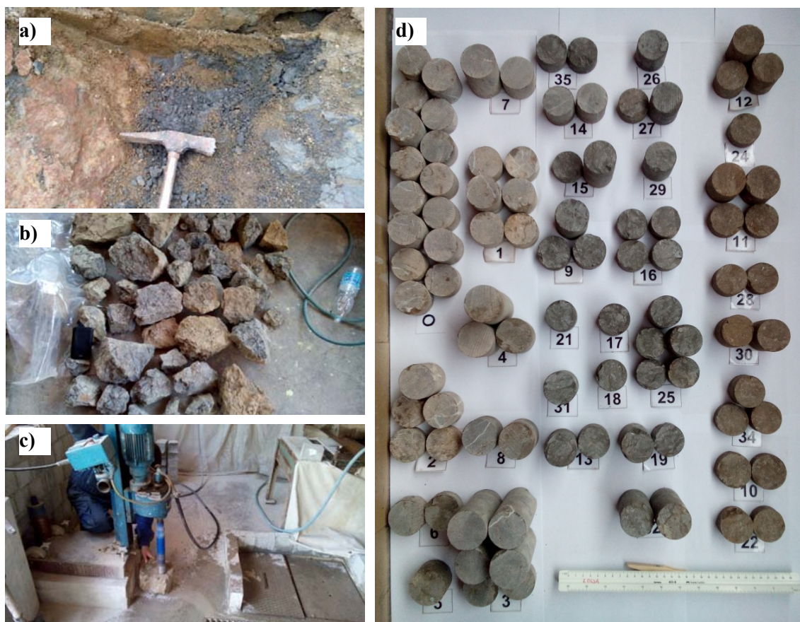
Slika 6.9 Proces izrade uzoraka a) Uzimanje blokova stene iz istražne jame, b) Izgled blokova siltita, c) Bušenje komada stene, d) Završni izgled pojedinačnih diskova
