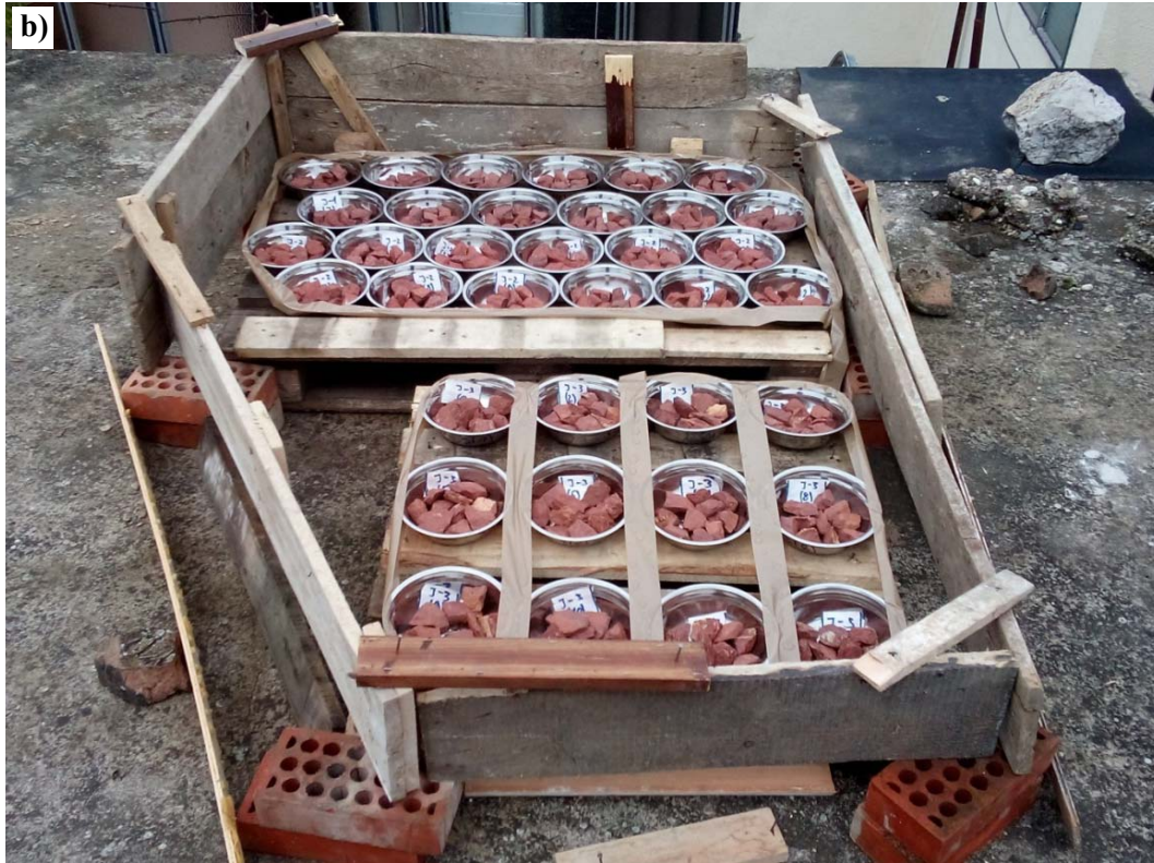
Slika 7.17 a) Transport uzoraka do pogodne lokacije i postavljanje na palete, b) Finalni izgled uzoraka izloženih dejstvu atmosferskih uticaja
