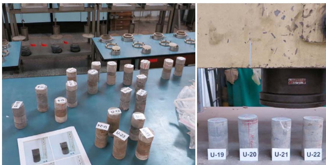
Slika 6.10 Izgled kompozitnih uzoraka pripremljenih za ispitivanje
