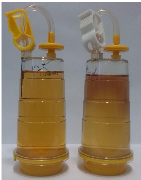
Slika 3.1. Odsustvo rasta mikroorganizama na tečnim podlogama TSB i Tio u testu sterilnosti (metoda membranske filtracije, u protočnim kontejnerima Steritest™)
