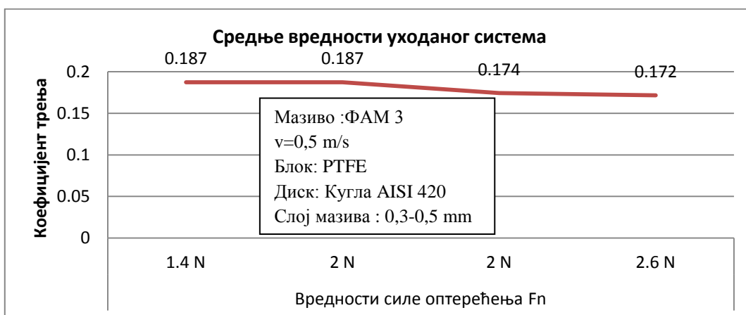
Дијаграм 9.5 Средње вредности коефицијента трења од момента уходавања система (за процењених 6 секунди)
