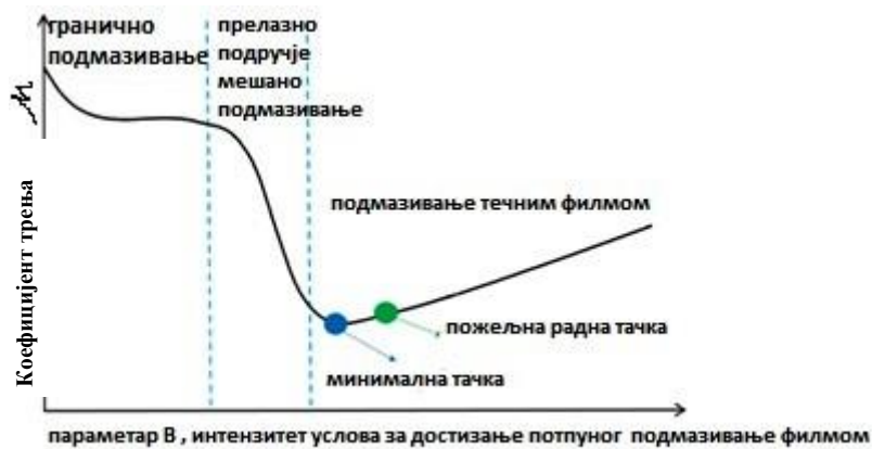
Слика 5.11 Стрибекова крива која илуструје режиме подмазивања
