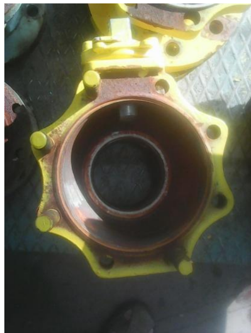
Слика 7.25 Изглед расклопљене кугласте славине и належућих површина
