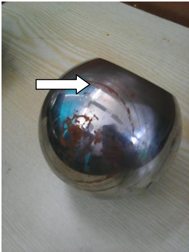
Слика 7.22 Изглед кугле и дејства абразије
