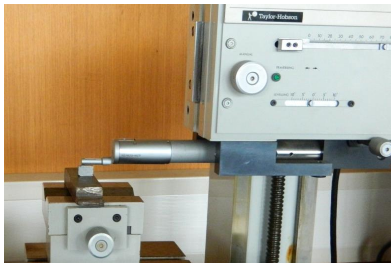
Слика 7.16 Дијамантска игла профилометра
