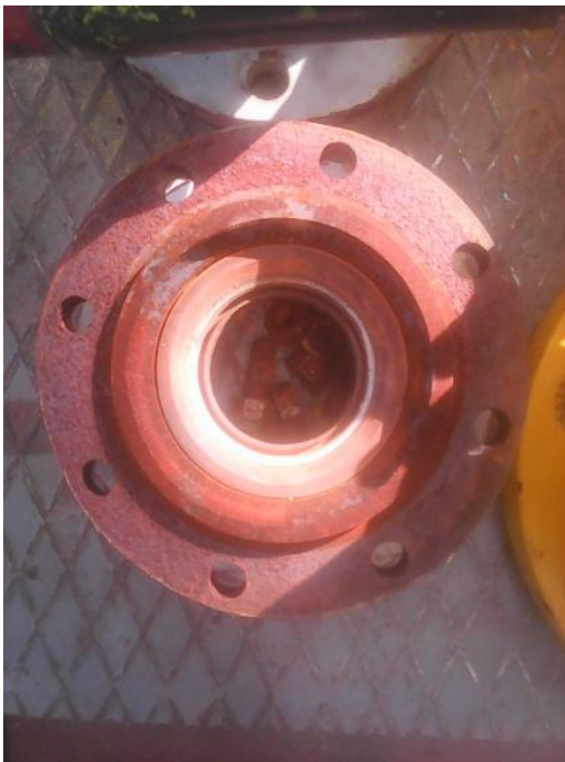
Слика 7.24 Изглед належућих површина кугласте славине
