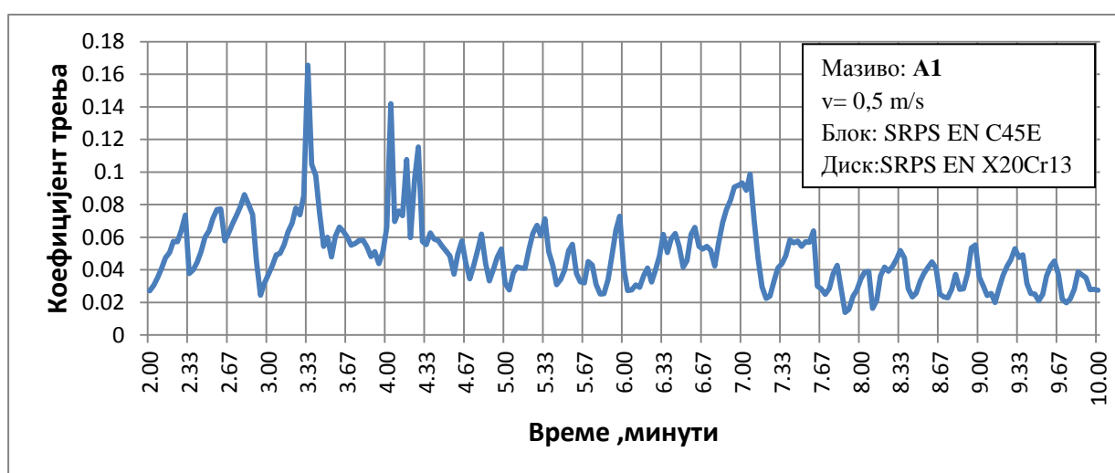
Слика 8.29. Интервал у коме је вршено пребројавање броја додавања мазива А1
