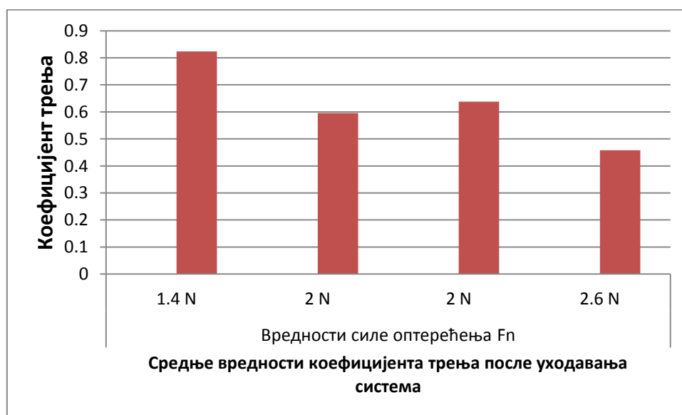
Дијаграм 8.9 Средње вредности коефицијента трења од процењених 20 секунди, тј од момента уходавања(ефектуирања) система, за мазиво А1
