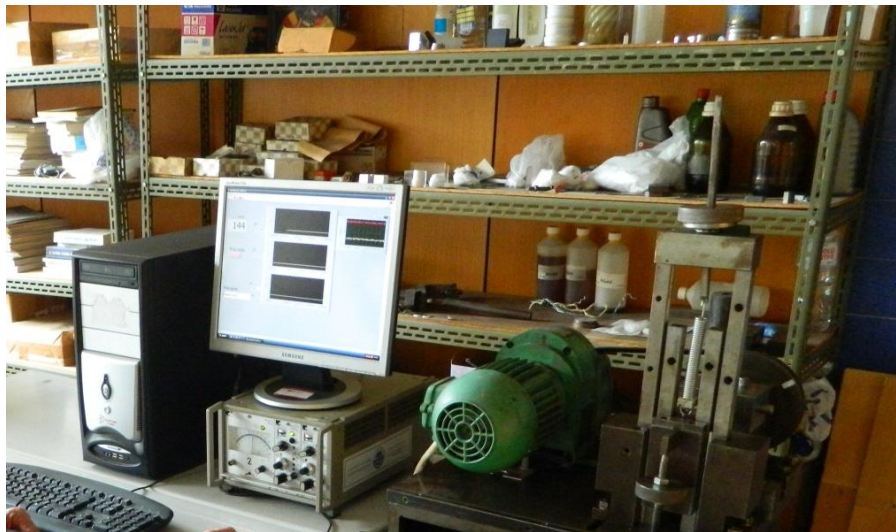
Слика 7.11 Трибометар TPD-93 са мерном и рачунарском опремом
