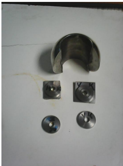
Слика 7.37 Поступак израде дискова од одабраног материјала кугле из експлоатације
