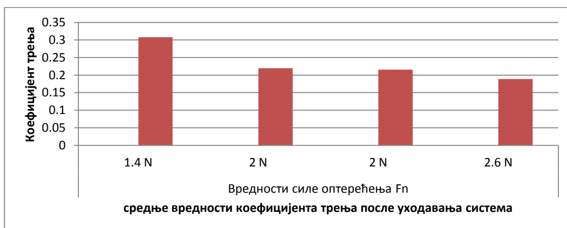
Дијаграм 8.8 Средње вредности коефицијента трења од момента уходавања система (за процењених 6 секунди ), ФАМ 3
