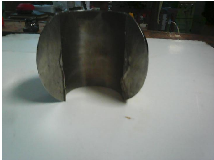
Слика 7.36 Пресек узорка кугле, кугласте славине
