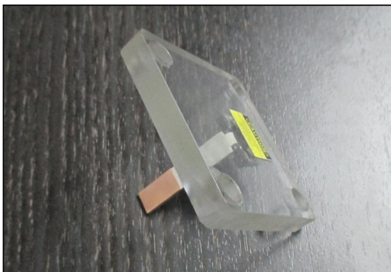
Slika 3.8.3.5 Izgled poklopca komore od klirita sa mogućnošću aksijalne translacije nosača mete, kao dodatnog stepena slobode pozicioniranja. Na nosaču se nalazi tipičan bakarni uzorak.
