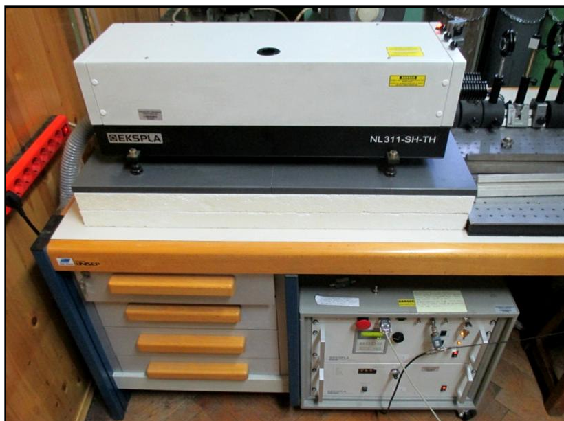
Slika 2.1.3 Izgled korišćenog nanosekundnog Nd:YAG laserskog sistema EKSPLA NL311-SH-TH.
