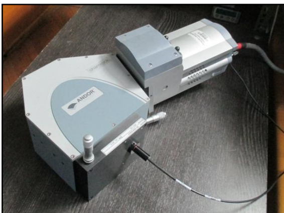
Slika 2.3.1.5 Detekcioni sistem: ICCD kamera Andor iStar DH740 i spektrograf Andor Shamrock SR-163 (levo) i Cu spektar širokog intervala talasnih dužina (desno).
