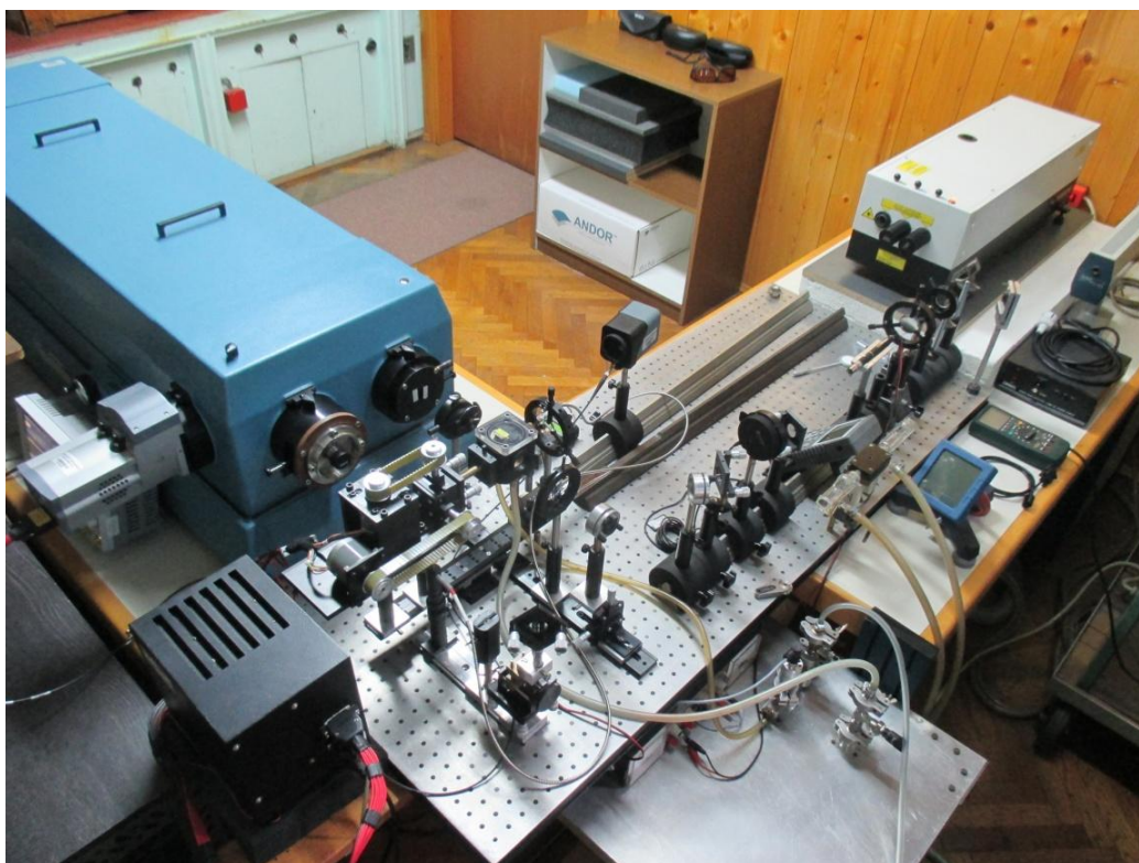
Slika 2.4.2 Eksperimentalna postavka za emisionu spektroskopiju laserski-indukovane plazme.
