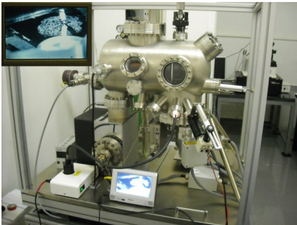
Слика П.4. Микроскоп Omicron B002645 SPM probe VT AFM 25. У инсету слике је приказан процес мерења STM иглом на нанокристалном праху.
