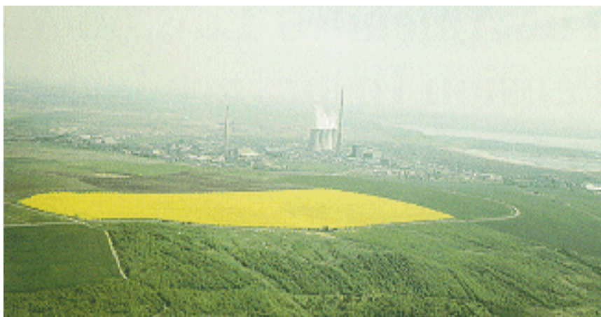
Слика 1.30. - Зарављени врхови одлагалишта су често рекултивисани у пољопривредне површине, а шуме су сађене на косинама. Рекултивисана одлагалишта површинског копа Меркур код града Kadan у северној Бохемији. ČEZ-Tusimice топлана је у позадини
