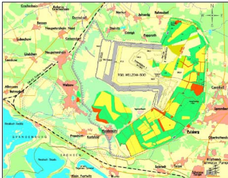
Слика 1.11. - Обликовање и рекултивација површинског копа Cottbus-Sud
