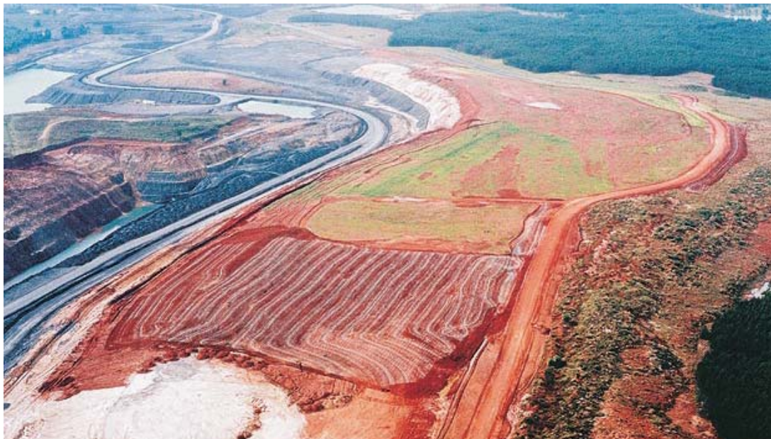
Слика 4.6. - Рекултивација на формираном одлагалишту током процеса експлоатације угља са контролисаним ерозионим процесом у централном делу и засадом траве, и пошумљеним багремаром у горњем делу изнад одлагалишта
